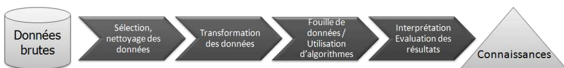
FIGURE 2.4 – Processus d'Extraction de Connaissances à partir de Données, adapté de [FPSS96]
