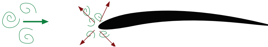
Fig. 1.4: Schéma du bruit de bord d'attaque.
