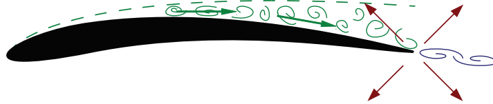
Fig. 1.3: Schéma du bruit de bord de fuite : diffraction des structures turbulentes.
