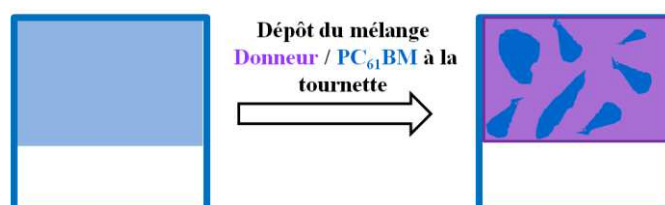
Figure B - 4 : Dépôt de la couche active pour une cellule en réseaux interpénétrés
