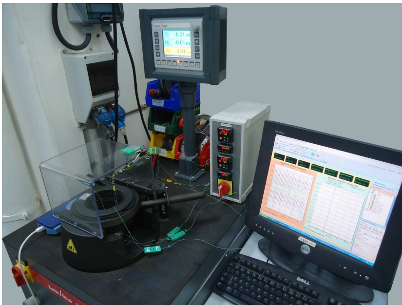
FIGURE 3.17 – Dispositif d'emboutissage en température implémenté sur une machine d'essai BUP200.
