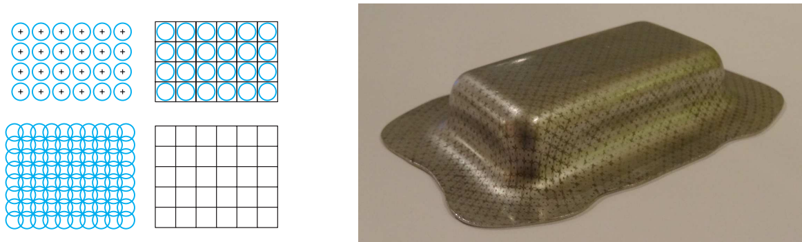
FIGURE 2.16 – Différents types de grilles permettant le calcul des déformations en emboutissage [Col, 2002] (à gauche) et pièce emboutie possédant un réseau de cercle (à droite).
