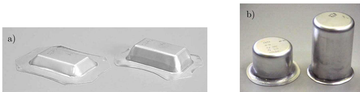
FIGURE 3.1 – Exemples de pièces en AA5754-O embouties en température. a) Emboutis coniques, les plus profonds, obtenus à température ambiante (gauche) et à 250 °C (droite) [Bolt et al., 2001]. b) Godets cylindriques, les plus profonds, à température ambiante (gauche) et à 250 °C (droite) [Bolt et al., 2003]
