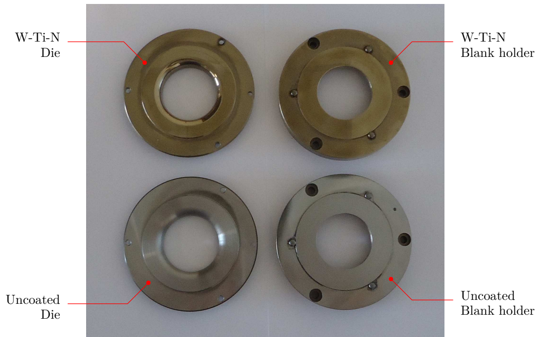
FIGURE 3.14 – Jeux d'outils revêtus et brut d'usinage
