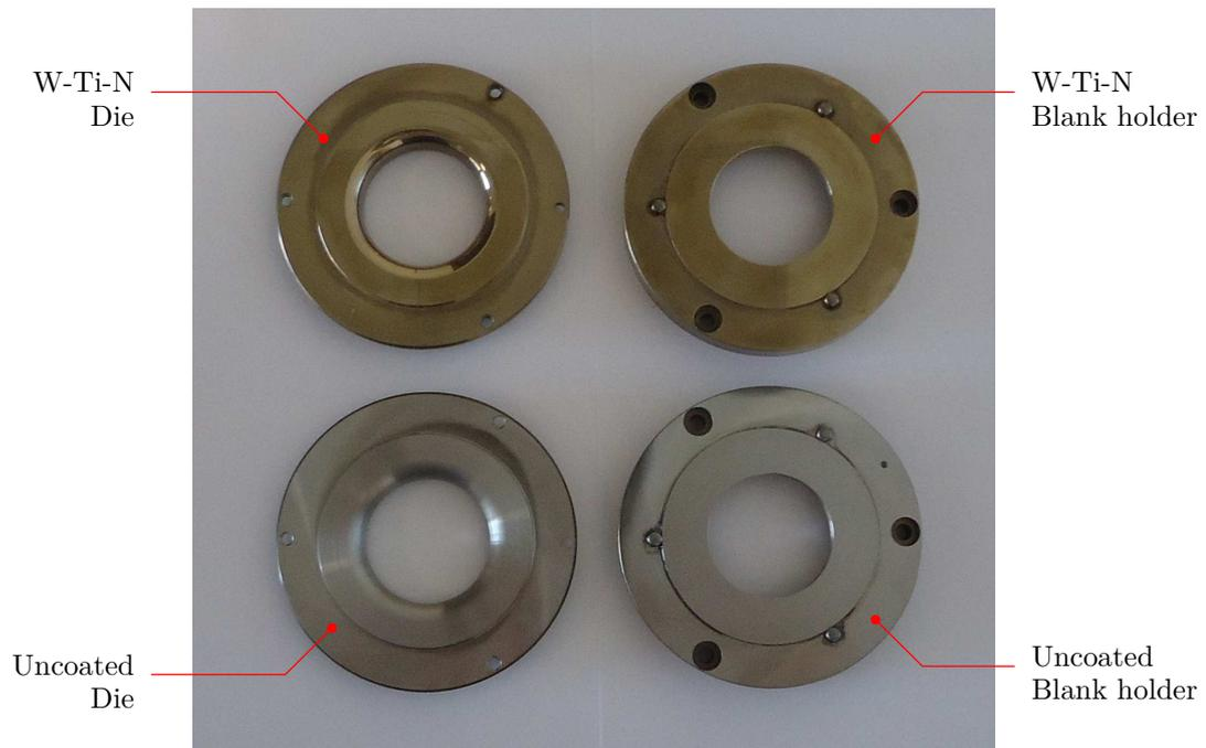
FIGURE 3.14 – Jeux d'outils revêtus et brut d'usinage
