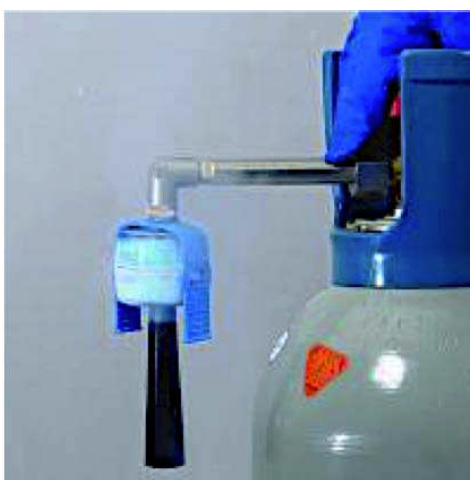
FIGURE 3.10 – Machine à glace carbonique SnowPack ® connectée à une bouteille de gaz. Crédit ©VWR International.
