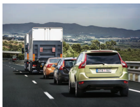
FIGURE 2.1 – Convoi de véhicules autonomes en file indienne, réalisé dans le cadre de projet SARTRE sur une autoroute publique en mai 2012 à Barcelone.
