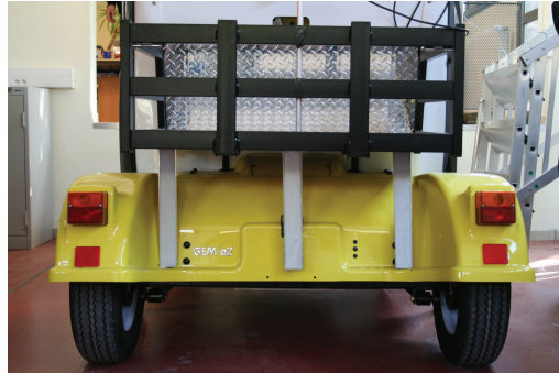
FIGURE 8.9 – Balises réfléchissantes installées à l'arrière d'un véhicule suivi.
