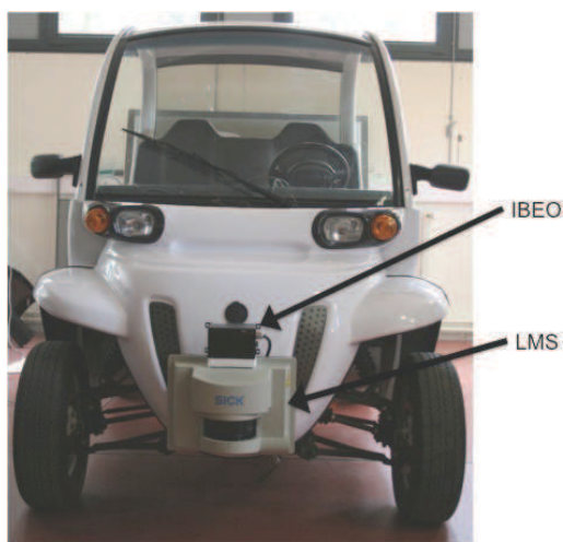
FIGURE 8.8 – Capteurs installés sur les véhicules GEM du laboratoire SeT.
