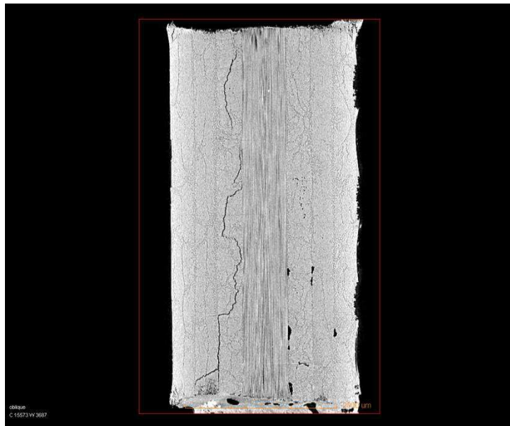
Figure 4.43 : Vue en coupe selon le plan (13) d'un stratifié [\pm 45/90/0]_S ayant subi un essai d'auto-échauffement jusqu'au chargement maximum, comme indiqué sur la Figure 4.42.
