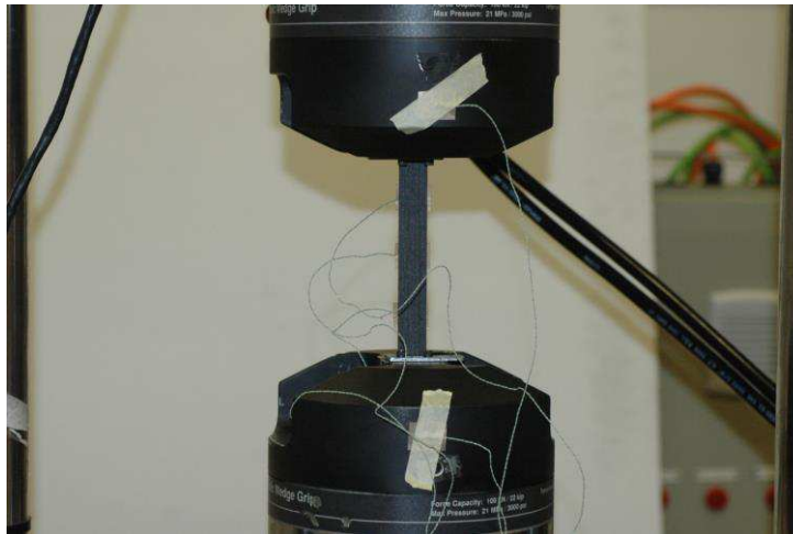
Figure 3.47 : Disposition des thermocouples sur l'ensemble machine+ éprouvette
