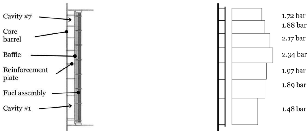
(a) Identification de cavités dans la dérivation entre les plaques de renfort du cloisonnement
