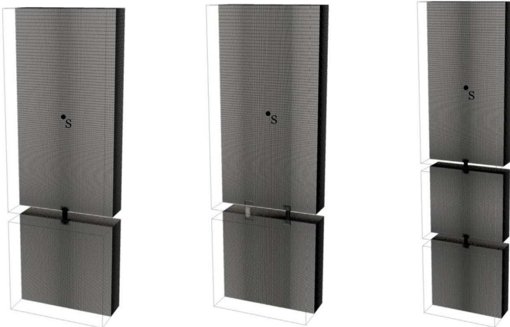
Figure 110 : Configuration de calcul pour la calibration d'impédances pour les plaques perforées
