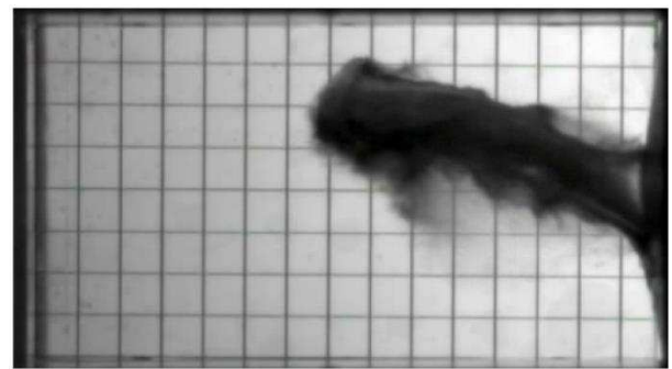
(b) Jet initial pour une ouverture préfissurée en U (après 1.75 ms)
