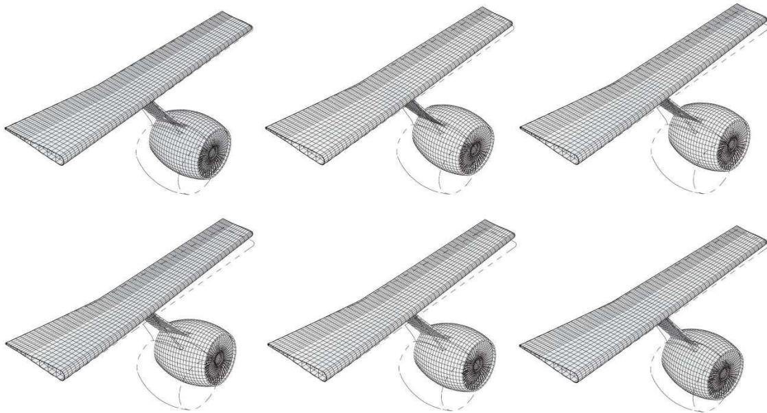
Figure 6 : Simulation du premier mode d'ébranlement de l'aile
