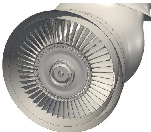
Figure 135 : Perte de pales sur un rotor – Etat initial
