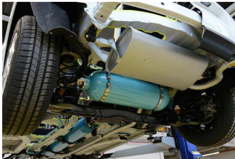
FIGURE 1.2 – Les réservoirs d'air sous pression montés sous une voiture Peugeot 308.
