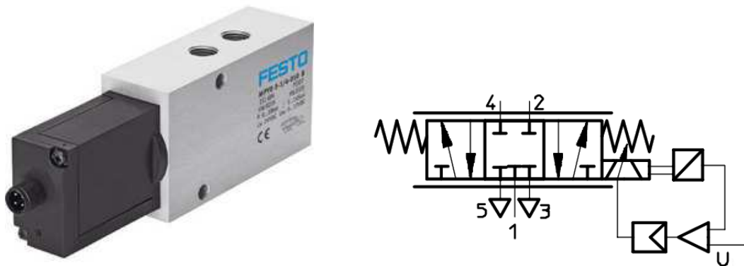
FIGURE 1.5 – Le distributeur MPYE utilisé et son schéma de principe.
