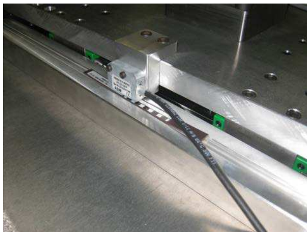
FIGURE 2.12 – Le capteur de position Posimag et sa réglette de mesure.
