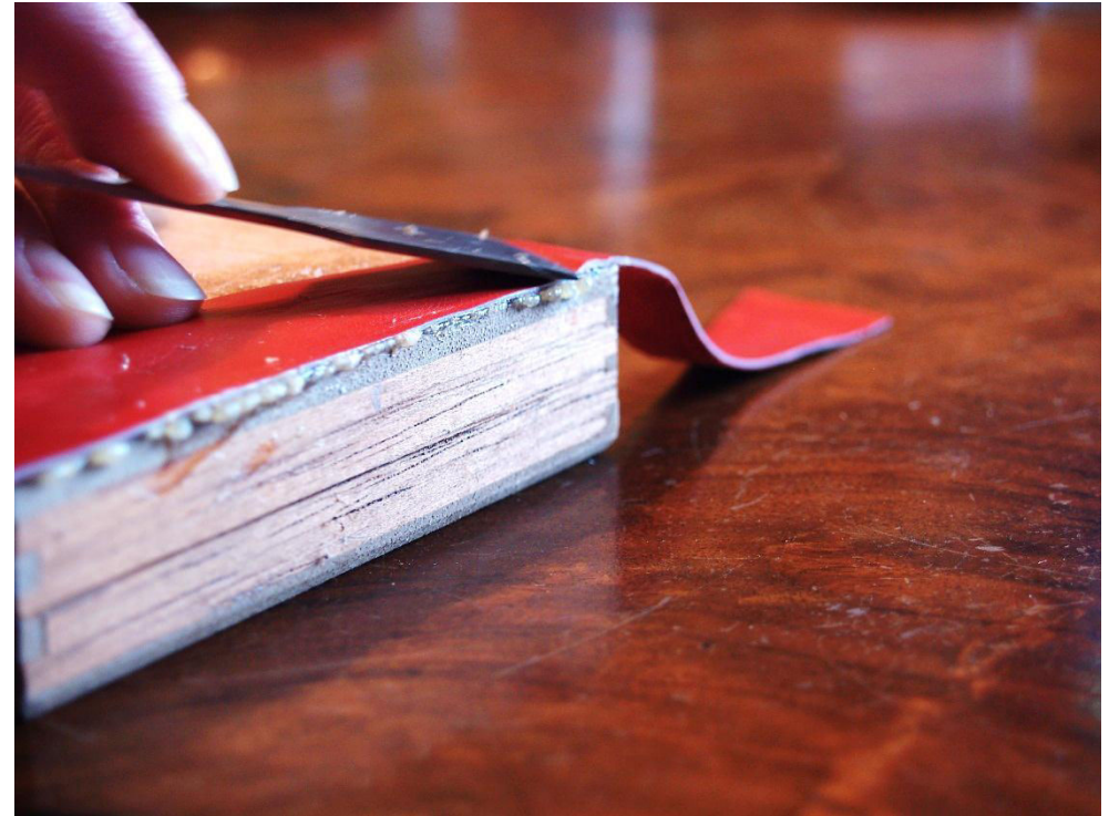
187 Détails de fils et débordements de colle néoprène.
