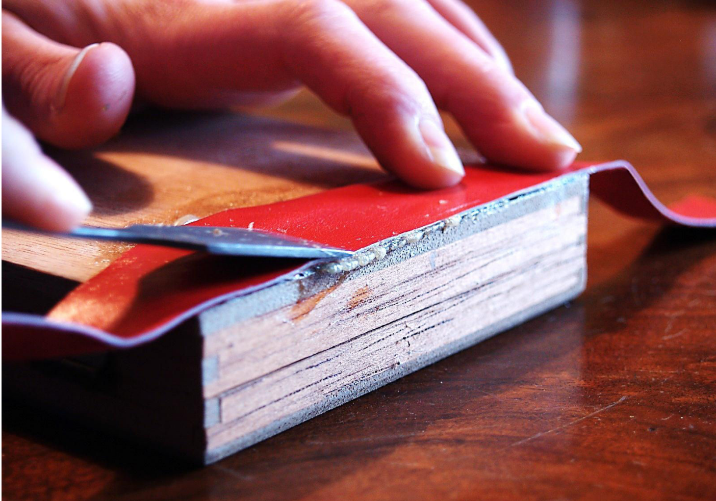
73 Gros plan d'encollage de cuir à la colle néoprène, marouflage au moyen de notre "cuillère plate".
