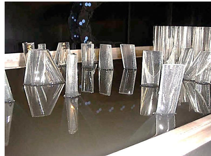
226 Extraction des pièces de la série Solid des machines à stéréolithographie.
