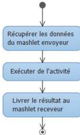
Figure 35 : Diagramme d'activité UML de l'exécution d'un wiring
