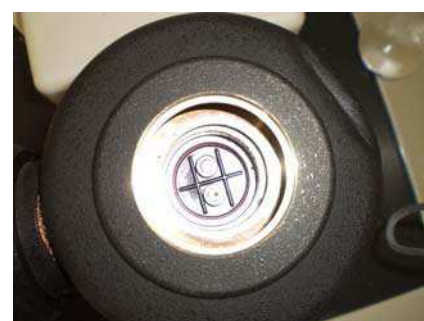
FIGURE 3.3 – Intérieur du four du calorimètre TA-instrument mDSC-2920. Le creuset de mesure est hermétiquement fermé puis percé.
