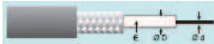
Figure 4.41 : Schéma du câble coaxial
