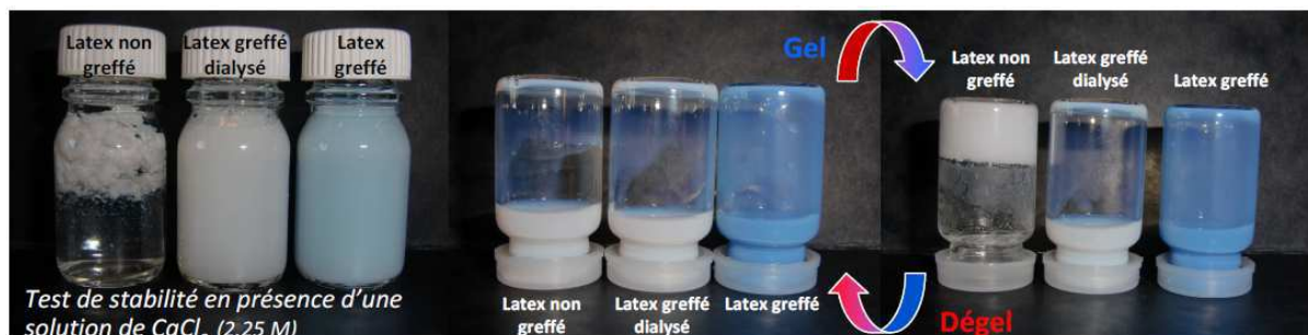
Figure 13. Tests de stabilité des latex greffés à la force ionique et au cycle gel/dégel.
