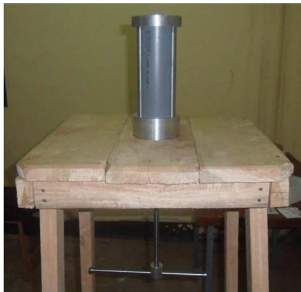
Fig. 3.7 – Dispositif mécanique d'extraction du sol
