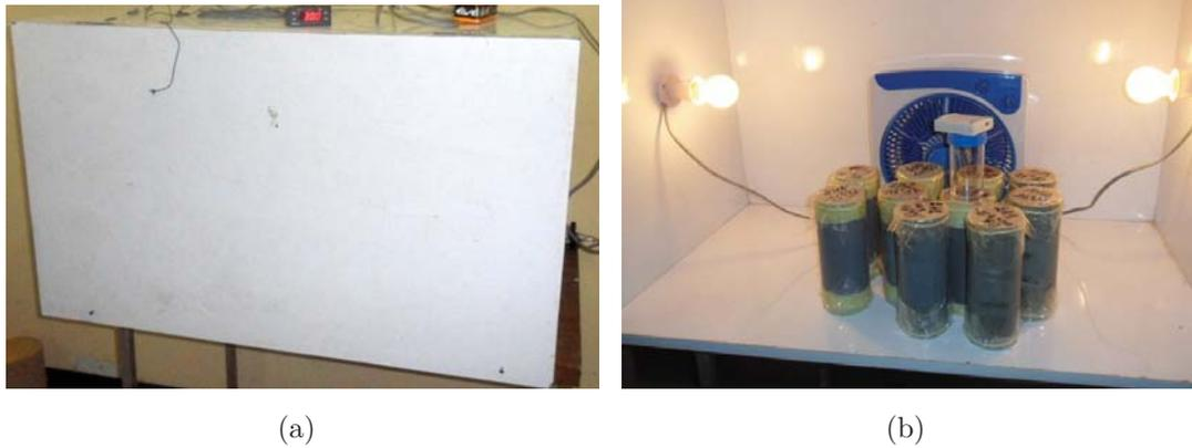
Fig. 3.6 – Enceinte régulée en température contenant les colonnes de sol : (a) enceinte fermée (b) enceinte ouverte
