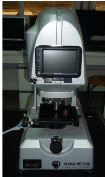
Figure 50. Photographie du profilomètre 3D Wyko NT1100
