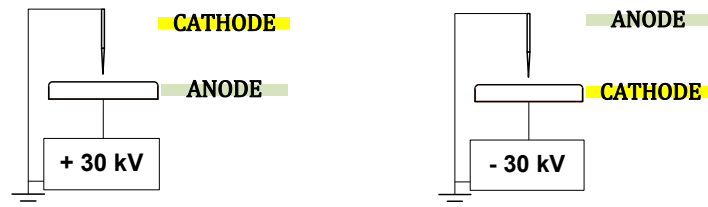
Figure 115. La configuration des électrodes avec les deux polarités de l'alimentation
