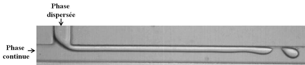
FIGURE 1.14 – Schéma représentatif de la génération de gouttelettes dans une jonction en T en régime jetting [55].
