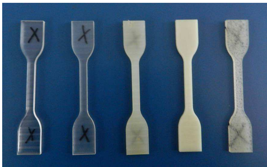
Figure 77 : Transparence des échantillons modifiés par une phase dispersée avec de gauche à droite : transparent, translucide, opalescent, opaque, tacheté
