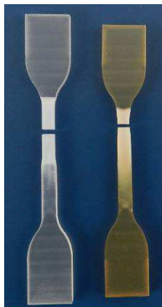
Figure 90 : Blanchiment sous contrainte des éprouvettes DER 332 + Jeffamine modifiés par le copolymère SBM (gauche) traction, (droite) choc Charpy
