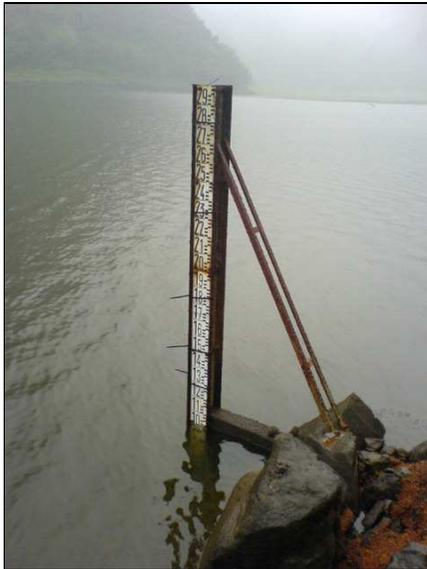
**Photographie 11 : L'échelle limnimétrique du Grand Etang (Réunion)**
