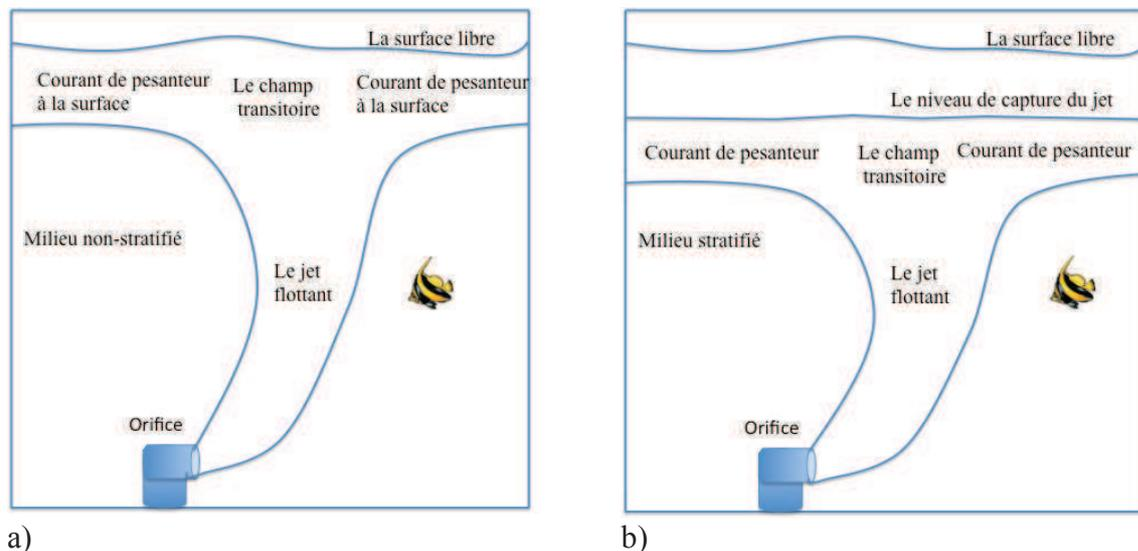
Figure 1- 12 Champ proche : a) Jet flottant dans un milieu nonstratifié ; b) Jet flottant dans un milieu stratifié.
