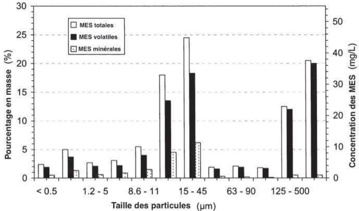
Figure 1- 3 Granulométrie des particules solides dans les réseaux d’assainissement unitaires en temps sec. Adapté de Verbanck et al. (1990) dans Ashley et al. (2004).
