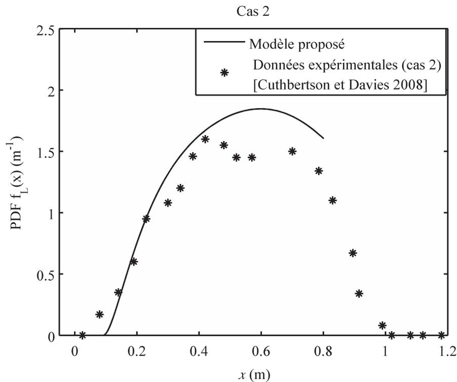
Figure 3- 10 Résultats de simulation pour le cas 2 « catégorie des jets horizontaux flottants dans un milieu stationnaire ». (a) La forme du jet ; (b) La vitesse axiale du jet et ses composantes ; (c) Le flux solide sur l'axe du jet ; (d) Validation de la courbe du taux de déposition longitudinale.
