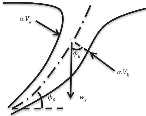
Figure 3- 6 La vitesse de déposition par rapport à la vitesse d'entraînement.
