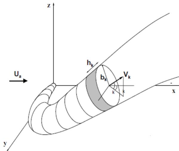
Figure 2- 5 Schéma de la trajectoire tridimensionnelle du jet tracée par des éléments lagrangiennes [Lee et Chu 2003].
