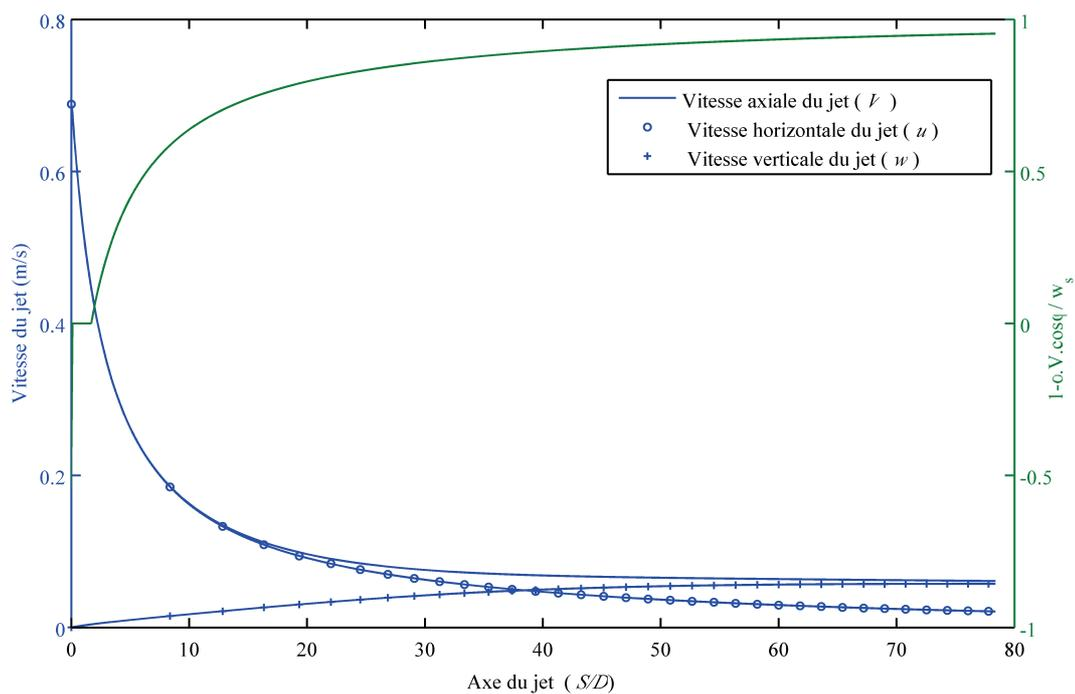
Figure 3- 7 Profil typique de la vitesse axiale du jet et évolution du paramètre  $(1 - \frac{\alpha V \cos \phi}{w_s})$ .
