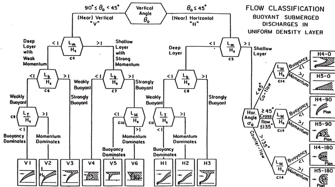
Figure 2- 8 Arbre de classification des écoulements par Cormix pour les jets flottants dans un milieu ambiant non stratifié [Doneker et Jirka 2007].
