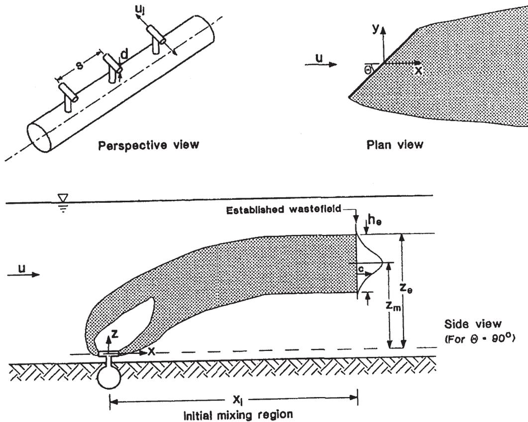
Figure 2- 7 La configuration de T-risers adopté dans le modèle NRFIELD [Roberts et al. 1989].
