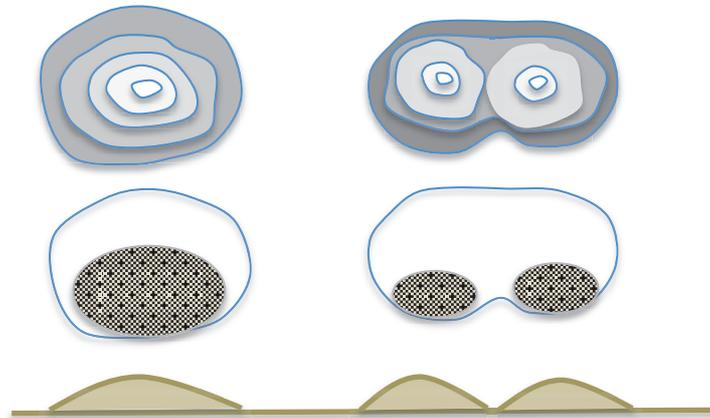
Figure 3- 5 En haut, la vorticité dans la section transversale des jets turbulents dans un milieu stationnaire ou en présence de co-courant (à gauche) et en présence de courant croisé (à droite). Au milieu, La concentration préférentielle de particules solides dans les zones de faible vorticité. En bas, dépôt localisé (à gauche) et le dépôt en forme d'anneau (à droite).
