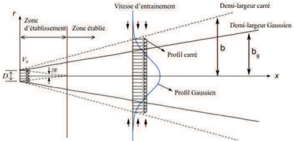
Figure 2- 3 Structure hydrodynamique d'un jet rond horizontal représenté par un profil Gaussien et un profil carré.
