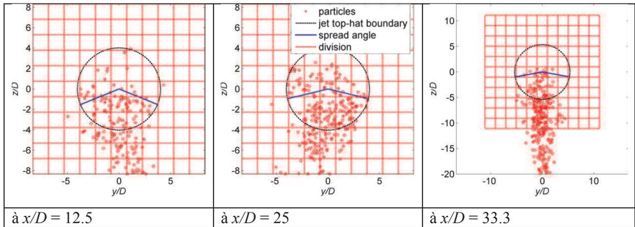
Figure 3- 4 Trois sections transversales dans le même jet horizontal chargé des particules de verre visualisé par une technique d'imagerie. Le contour noir présente les limites « top-hat » du jet [Lee 2010].
