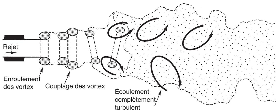
Figure 2- 1 Transition dans les jets turbulents. Adapté de [Versteeg et Malalasekera 1995].
