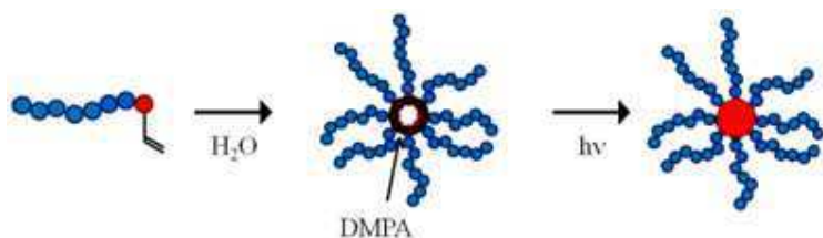
Figure 15 : Formation d'étoiles figées par photo-réticulation radicalaire des étoiles dynamiques POE- b -PAME.
