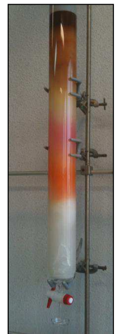
Figure 95 : Première étape de fractionnement par la colonne de Sephadex® LH-20.
