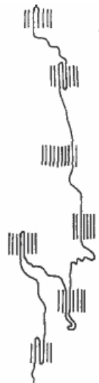
Figure 24 : Chemin d'une chaîne moléculaire au sein d'une fibre de PET [TEX. 93A]
