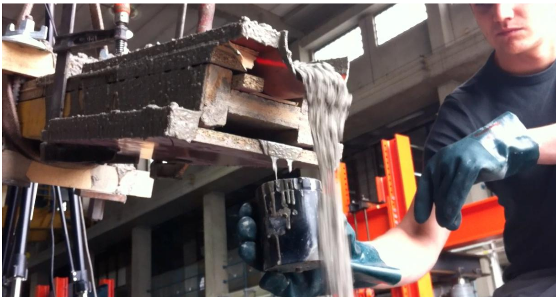
Figure 4-8 Récupération de la couche limite dans le récipient du rhéomètre de mortier Antonpaar MCR-52
