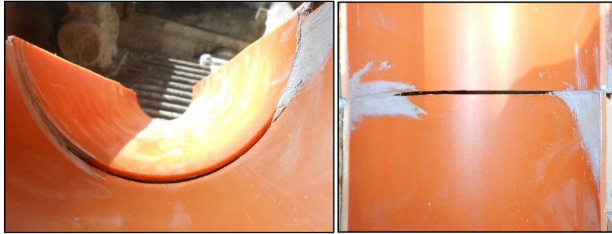
Figure 4-7 Vue de la fente dans la direction de l'axe (à gauche) et de dessus (à droite)
