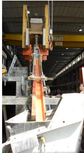
Figure 3-5 Conduite ouverte inclinée
