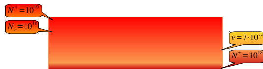
FIG. A.27: Vue en coupe des plaquettes sur lesquels seront fabriqués les JFET à simple grille
