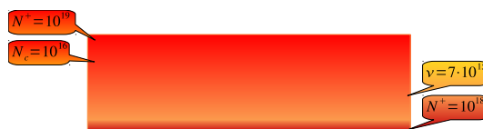
FIG. 4.8: Vue en coupe des plaquettes sur lesquels seront fabriqués les JFET à simple grille
