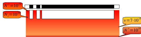
FIG. 4.9: Vue en coupe de l'étape de gravure RIE (les doigts font 2 \mu\text{m} de largeur et sont espacés de 3 \mu\text{m} )
