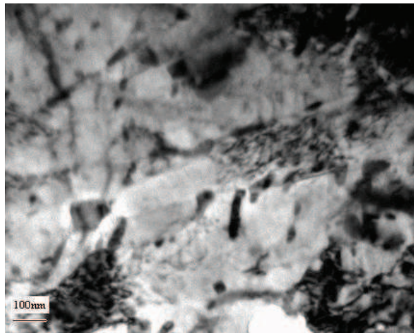
Figure 1 - Micrographie MET des précipités Cr_7C_3 dans le 35Cr.
