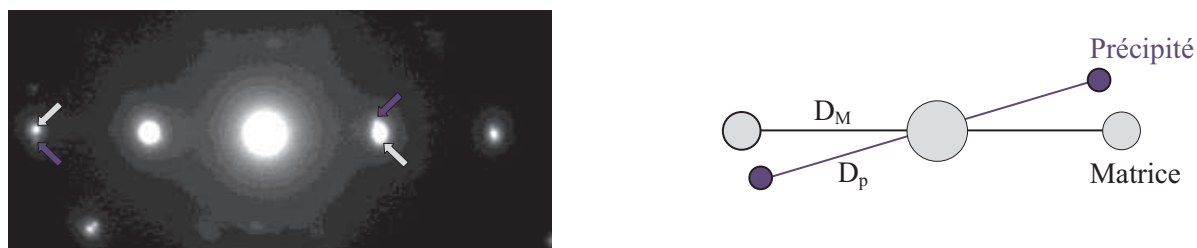
Figure 2 - Cliché de diffraction (a) et représentation schématisée (b) mettant en évidence le précipité considéré et permettant de calculer le taux de désaccord cristallographique.
