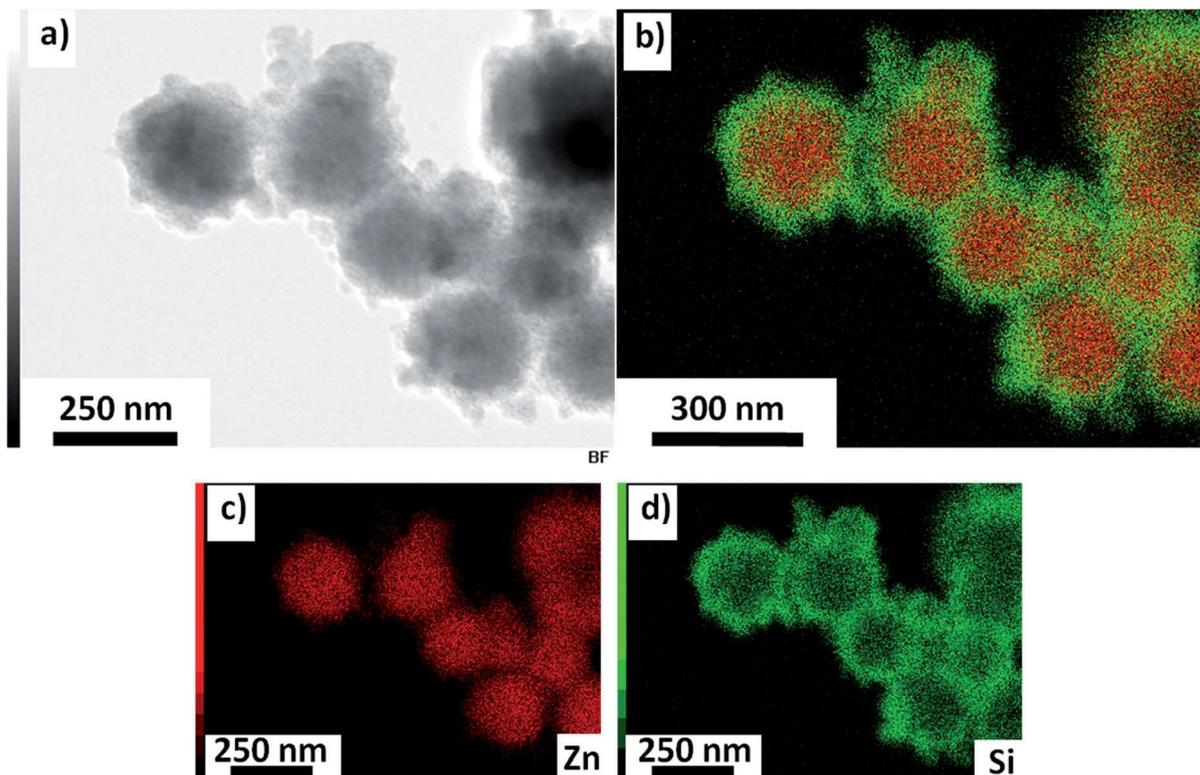
**Fig. III.23** - Images STEM d'un échantillon de ZO-01@SiO<sub>2</sub> pour une écorce de silice souhaitée de 30 nm (b) Cartographie STEM-EDX avec superposition des signaux de Zn et Si, (c-d) Cartographies STEM-EDX de Zn et Si respectivement.
