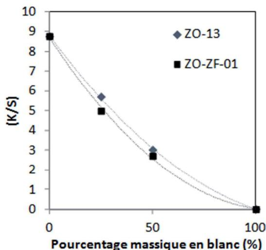
**Fig. III.10** -  $K/S$  moyen sur la gamme du visible pour des mélanges ZO-13/Co<sub>3</sub>O<sub>4</sub> et ZO-ZF-01/Co<sub>3</sub>O<sub>4</sub> en fonction du pourcentage massique de « poudre blanche » (ZO-13 ou ZO-ZF-01 respectivement). Note : la poudre utilisée pour l'élaboration de ZO-ZF-01 par fluoration plasma n'est pas issue du même lot que la poudre ZO-13 analysée ; des différences de morphologie sont donc très probablement à l'origine du faible décalage du coefficient  $S$ .
