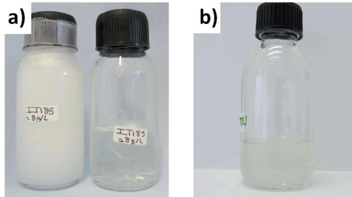
**Fig. III.33** – a) Photographie d'un échantillon de ZO-13-HDT dans CHCl<sub>3</sub> avant (à gauche) et après (à droite) passage aux ultrasons. b) Photographie d'un échantillon de ZO-13-DDT dans CHCl<sub>3</sub>.
