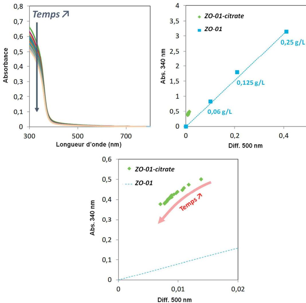
**Fig. III.29** – Suivi cinétique de spectres UV-Visible pour une solution de ZO-01-citrate et courbes représentant l'évolution de l'absorption à 340 nm en fonction de la diffusion à 500 nm associée à ces mesures. En bleu, la courbe référence pour le ZO-01 dans un mélange DEG-eau-éthanol (50, 1 et 49 % volumique respectivement).
