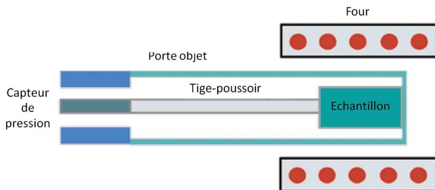
Fig. IV.8 – Schéma d'un dilatomètre horizontal à pousoir.
