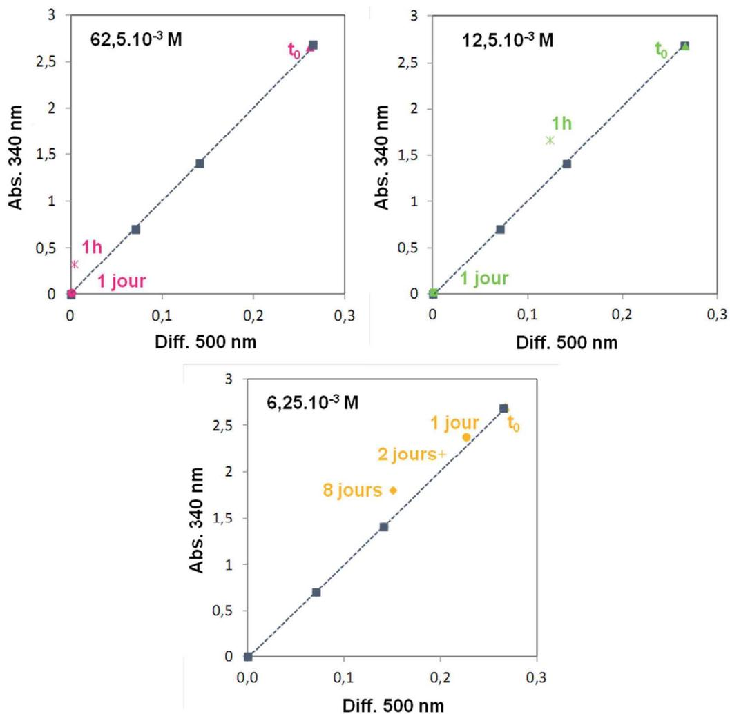
**Fig. III.31** – Evolution de l'absorption à 340 nm en fonction de la diffusion à 500 nm au cours du temps (de t<sub>0</sub> à plusieurs jours) pour différentes concentrations en acide acétique dans le mélange initial. En gris, la courbe référence pour le lot ZO-01.
