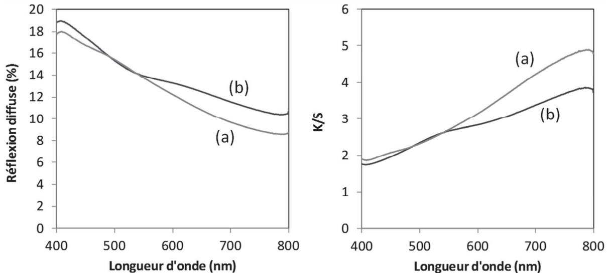
**Fig. III.9** - Mesures de réflexion diffuse dans la gamme de longueur d'onde du visible et rapports ( $K/S$ ) associés pour des mélanges 50/50 (rapport massique) de poudres : a) ZO-13/Co<sub>3</sub>O<sub>4</sub> et b) ZO-ZF-01/Co<sub>3</sub>O<sub>4</sub>.
