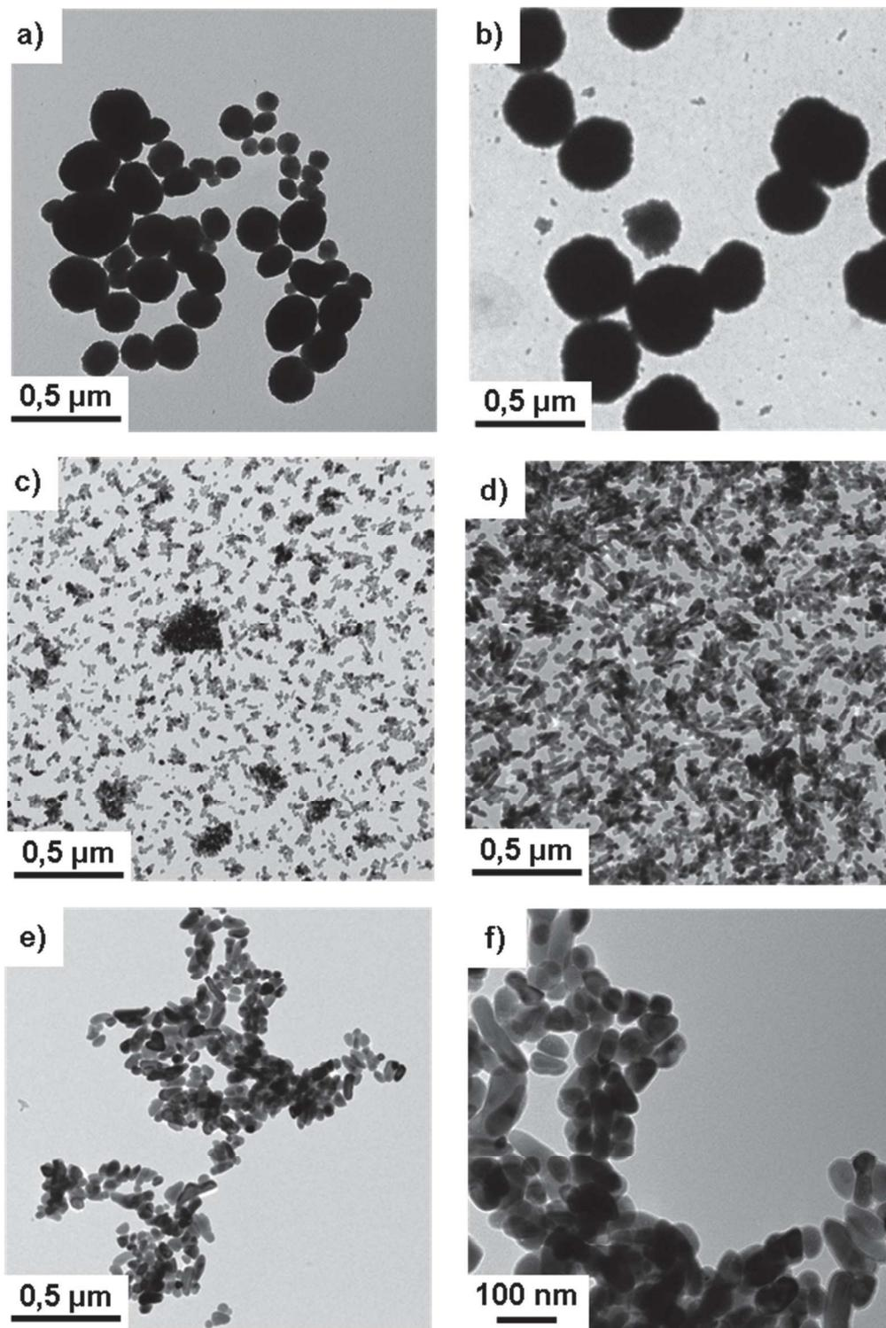
**Fig. II.19** - Clichés MET d'agglomérats de ZnO faiblement cohésifs et de nanocristallites dispersées : a,b,c,d,e) clichés d'échantillons élaborés respectivement avec 0, 50, 75, 90 et 100 % d'hexanol, f) cliché à plus fort grossissement obtenu pour un échantillon élaboré avec 100 % d'hexanol.
