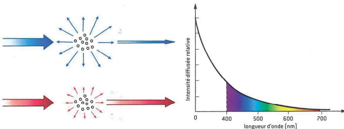
**Fig. I.6** - Diffusion de la lumière par des particules dont la taille est inférieure au dixième de la longueur d’onde. L’intensité diffusée, proportionnelle à  $1/\lambda^4$ , est plus importante dans le bleu que dans le rouge [7].
