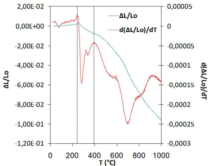
**Fig. II.9** – Analyse dilatométrique d’une pastille de ZO-01 lors d’un phénomène de montée en température de la température ambiante à 1000°C (vitesse de montée en température : 2°C/min).
