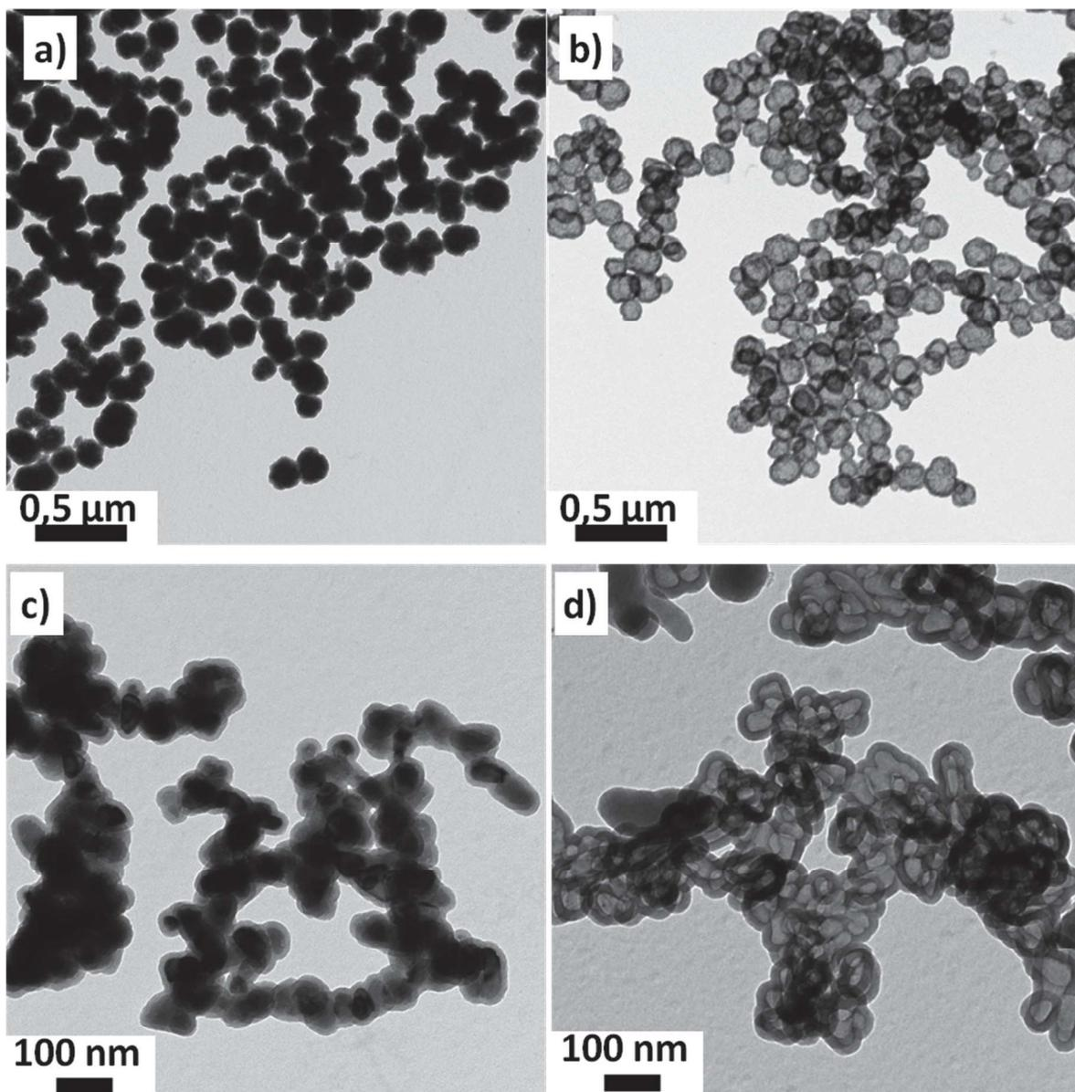
Fig. III.24 - Micrographies MET des particules de ZO-01@SiO<sub>2</sub> avant (a) et après (b) ajout d'HCl. Micrographies MET des particules de ZO-12@SiO<sub>2</sub> avant (c) et après (d) ajout d'HCl.
