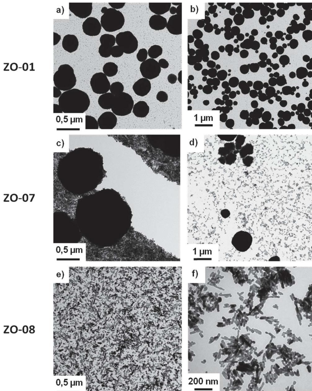
**Fig. II.17** - Clichés MET d'agglomérats de ZnO faiblement cohésifs et de nanocristallites dispersées : a,b) échantillon élaboré à 0,1 M, c,d) échantillon élaboré à 0,5 M et e,f) échantillon élaboré à 0,9 M.
