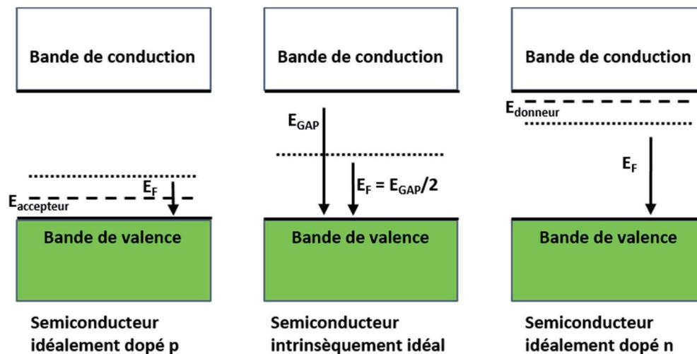
Fig. I.12 - Schéma de la position des défauts dans le gap.
