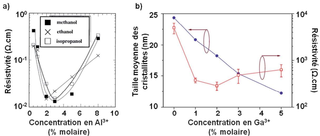
**Fig. II.41** – Evolutions en « cloche » répertoriée dans la littérature pour la conductivité pour de films minces de ZnO dopé à l'aluminium [200] (a) ou au gallium [196] (b) en fonction du taux de dopant.
