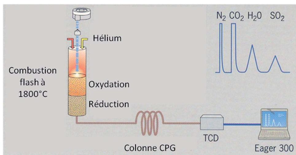
Fig. IV.2 – Schéma de principe d'une analyse CHNS [234].
