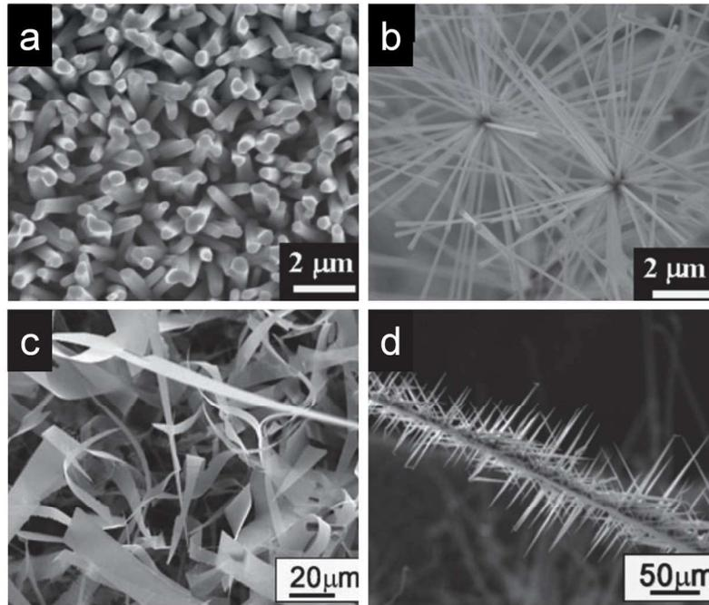
**Fig. 1.24** - Images de microscopie électronique à balayage de quelques morphologies accessibles par CVD. a) nanobaguettes [74], b) nanofils [74], c) nanofeuillets [75], d) arrangement de nanofeuillets en 3D [75].
