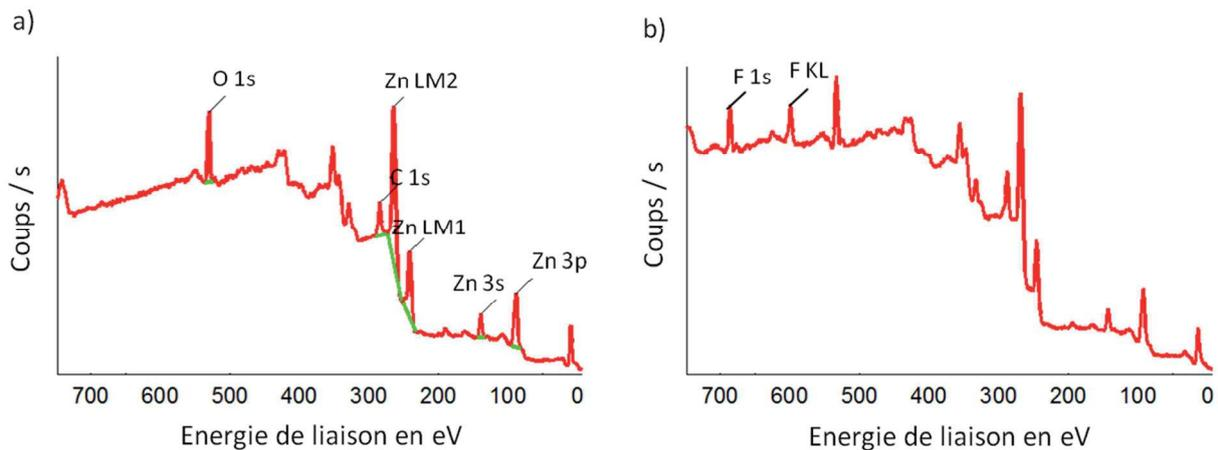
**Fig. III.5** – Comparaison des spectres XPS a) d'un échantillon de ZnO dopé au gallium (ZO-13) et b) d'un échantillon de ZnO dopé au gallium après fluoration par plasma de  $CF_4$  à température ambiante (ZO-ZF-01).
