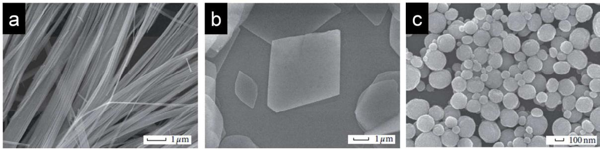
**Fig. 1.27** - Clichés de microscopie électronique en transmission de différentes morphologies de ZnO en voie polyol obtenues par Tseng *et coll.* a) Ethylene Glycol, b) Glycerol, c) Diéthylène Glycol [105].
