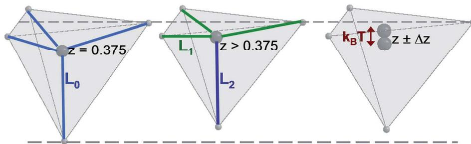
**Fig. II.24** – Représentation d’un site tétraédrique isotrope (à gauche), d’un site tétraédrique dans une structure würtzite (au milieu) et étalement des positions atomiques  $z$  lors de la simulation de vibrations thermiques (à droite).
