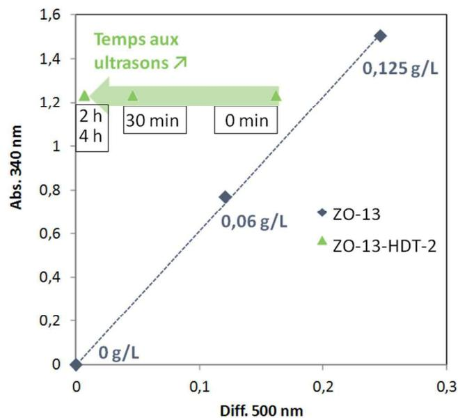
**Fig. III.38** – Evolution de l'absorption à 340 nm en fonction de la diffusion à 500 nm pour une suspension de ZO-13-HDT-2 dans le chloroforme en fonction du temps passé aux ultrasons. En gris, la courbe référence pour un lot de ZO-13 dans le chloroforme.
