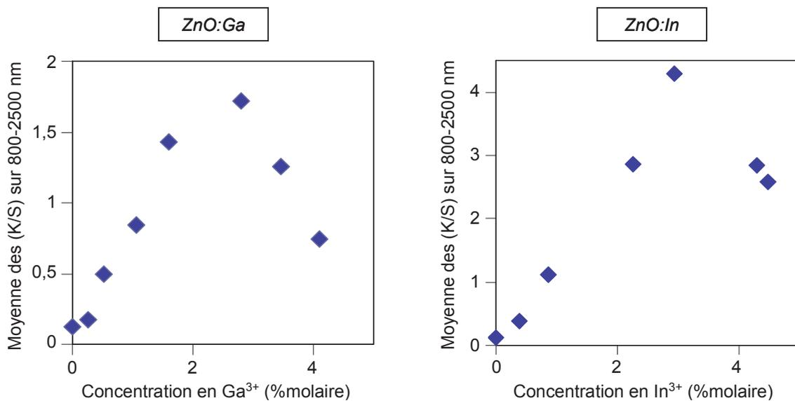
**Fig. II.36** – Evolution de l'absorption infrarouge en fonction de la concentration en dopant dans le cas de particules dopées au gallium (à gauche) et dans le cas de particules dopées à l'indium (à droite).
