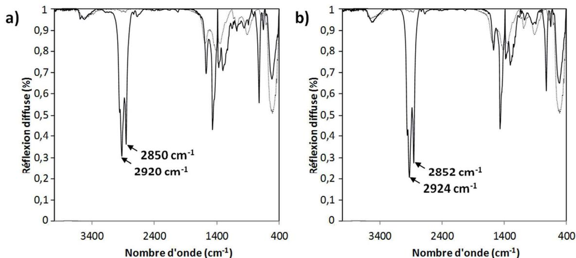
**Fig. III.36** – Spectre FTIR mesuré par réflexion diffuse, après correction de la ligne de base, pour des échantillons a) ZO-13-HDT et b) ZO-13-DDT (à droite). Les courbes obtenues sont représentées par une ligne continue. En pointillés est représentée la référence pour l'échantillon ZO-13.
