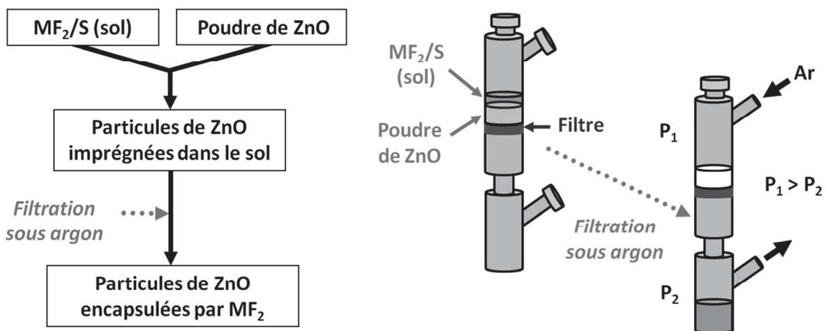
**Fig. III.11** - Représentation schématique du procédé d'encapsulation de particules de ZnO par des fluorures métalliques. Dans cette figure, S fait référence au solvant : méthanol pour  $MgF_2$ , méthanol avec quelques traces d'eau pour  $ZnF_2$ .  $P_1$  et  $P_2$  font référence aux pressions à l'intérieur du système.
