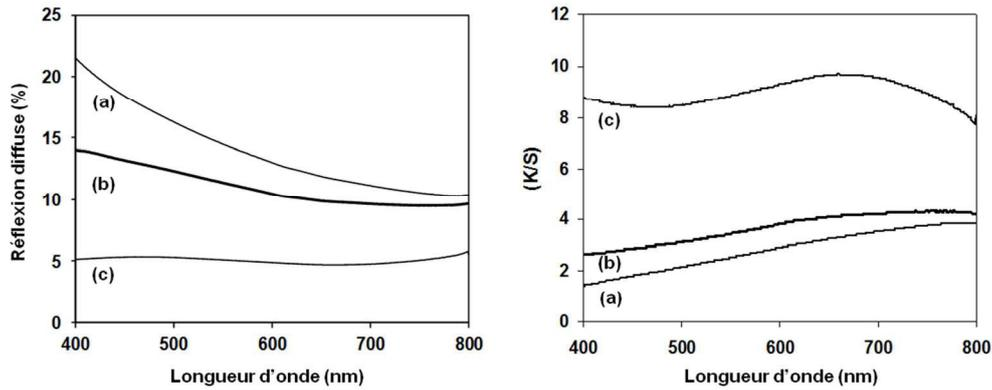
**Fig. III.15** - Mesures de réflexion diffuse dans la gamme de longueur d'onde du visible (400-800 nm) et rapports (K/S) associés pour des mélanges 50/50 (rapport massique) de poudres : a) ZnO/Co<sub>3</sub>O<sub>4</sub>, b) ZnO@MgF<sub>2</sub>/Co<sub>3</sub>O<sub>4</sub>, c) MgF<sub>2</sub>/Co<sub>3</sub>O<sub>4</sub>.
