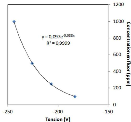
Fig. III.3 – Courbe d'étalonnage de l'électrode spécifique de fluor (ici  $LaF_3$ ) par des solutions de NaF.
