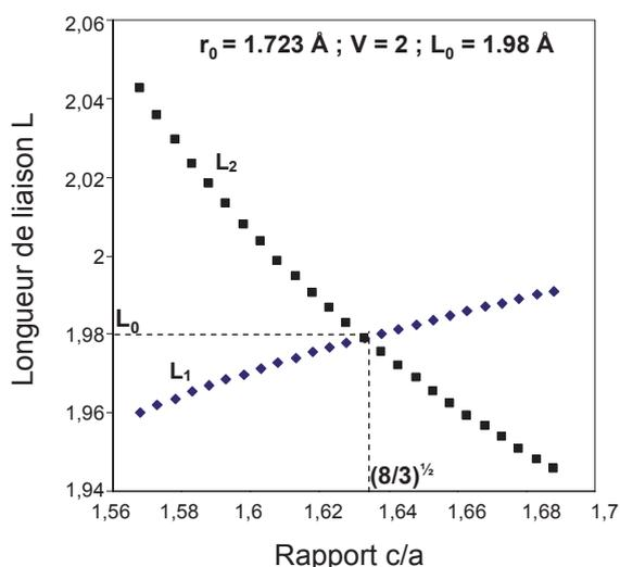
**Fig. II.28** – Evolution des longueurs de liaison  $L_1$  et  $L_2$  en fonction de l'aplatissement/extension des tétraèdres pour une structure avec une valence  $V = 2$  et un paramètre  $r_0 = 1,723$  Å (c'est-à-dire des paramètres identiques à un composé ZnO de structure würtzite).
