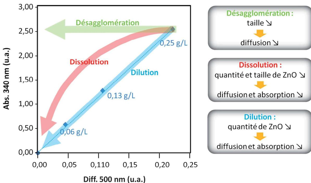
**Fig. III.28** – Comportement prévisionnel de l'absorption à 340 nm en fonction de la diffusion à 500 nm pour une dispersion de ZnO de type agglomérats submicroniques pour différentes situations : dilution (flèche bleue), désagglomération (flèche verte) ou dissolution des particules (flèche rouge).
