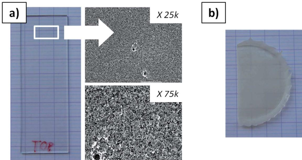
a) Photographie d'un film réalisé par dip-coating sur lame de verre à partir de suspension nanocolloïdales de ZnO et clichés de microscopie optique associés (grossissements : 25000 et 75000), b) Photographie d'un film composite PMMA – nanoparticules de ZnO.
