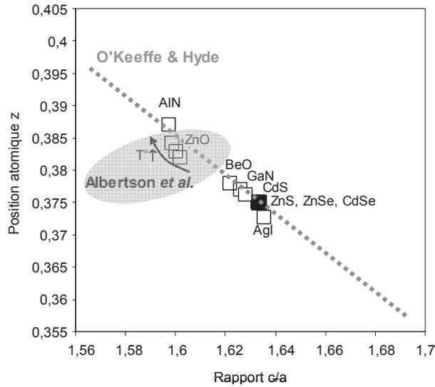
**Fig. II.25** – Relation linéaire entre la position atomique  $z$  et le rapport  $c/a$  pour des composés de type wurtzite proposée par O'Keefe et Hyde (la loi est tracée en présence des valeurs expérimentales de la littérature [190]). Les valeurs obtenues par Albertsson et coll. [191] pour la zincite analysée à différentes températures sont aussi représentées dans la zone grisée.
