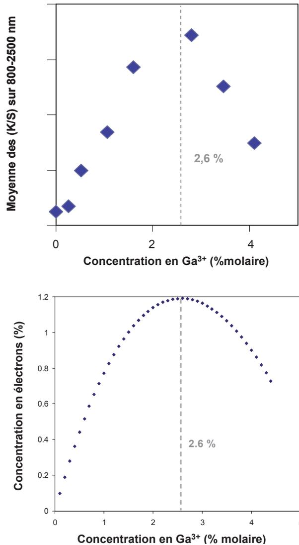
**Fig. II.42** – Comparaison de l'évolution de l'absorption dans le proche infrarouge (800-2500 nm) et de l'évolution de la concentration en densité électronique selon le modèle de « triple défaut » en fonction de la concentration en  $\text{Ga}^{3+}$ .
