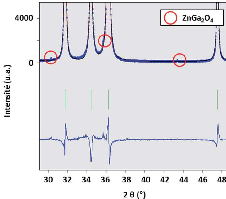
**Fig. II.40**– Diffractogrammes de rayons X et affinements Rietveld pour un modèle anisotrope selon l'axe (110) d'un échantillon de ZnO dopé à 2,8 % molaire de gallium. Les données expérimentales et calculées apparaissent superposées en haut de l'image, et la fonction différence est présentée en bas de l'image. Entourés en rouge, se trouvent les pics de diffraction correspondant à la phase ZnGa<sub>2</sub>O<sub>4</sub>.
