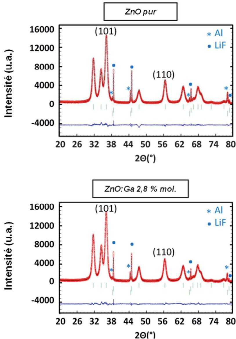
**Fig. II.33** – Affinements de type Rietveld pour un échantillon ZnO pur (en haut) et un échantillon ZnO dopé avec 2,8 % molaire en gallium (en bas). Ici de la poudre LiF a été introduite dans des proportions similaires dans les deux échantillons (à savoir 10 % massique).
