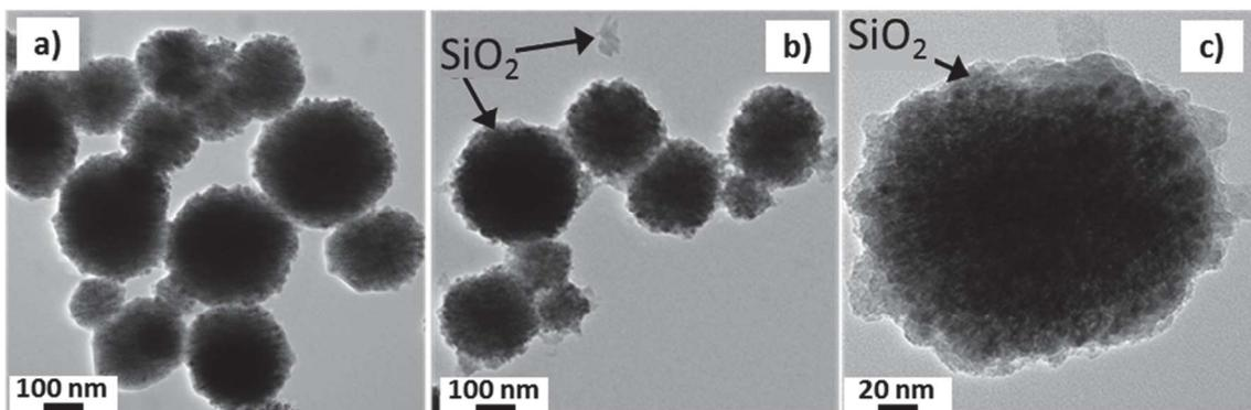
**Fig. III.22** – Micrographies MET d'agglomérats de ZnO submicroniques pour la réalisation de ZO-01@SiO<sub>2</sub> avant (a) et après (b-c) addition du TEOS dans le milieu réactionnel.
