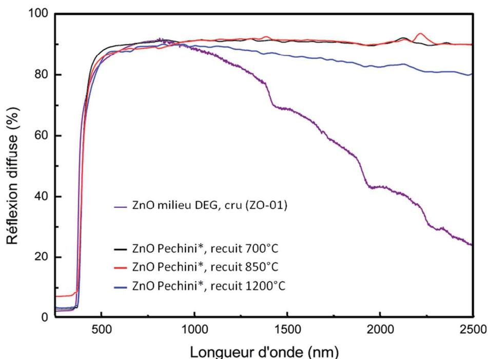
**Fig. II.5** - Spectres de réflexion diffuse pour la poudre ZnO (ZO-01) issue de la synthèse en milieu DEG et comparaison avec des spectres obtenus pour des poudres de ZnO obtenues par procédé Pechini avec différentes températures de recuit [54].
