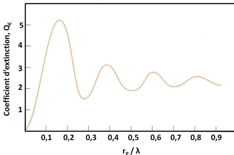
**Fig. 1.7** – Courbe modélisant le coefficient d'extinction  $Q_E$  à une longueur d'onde de 550 nm pour une particule de  $\text{TiO}_2$  d'indice optique 2,7 dispersée dans une huile d'indice optique 1,5 [10].
