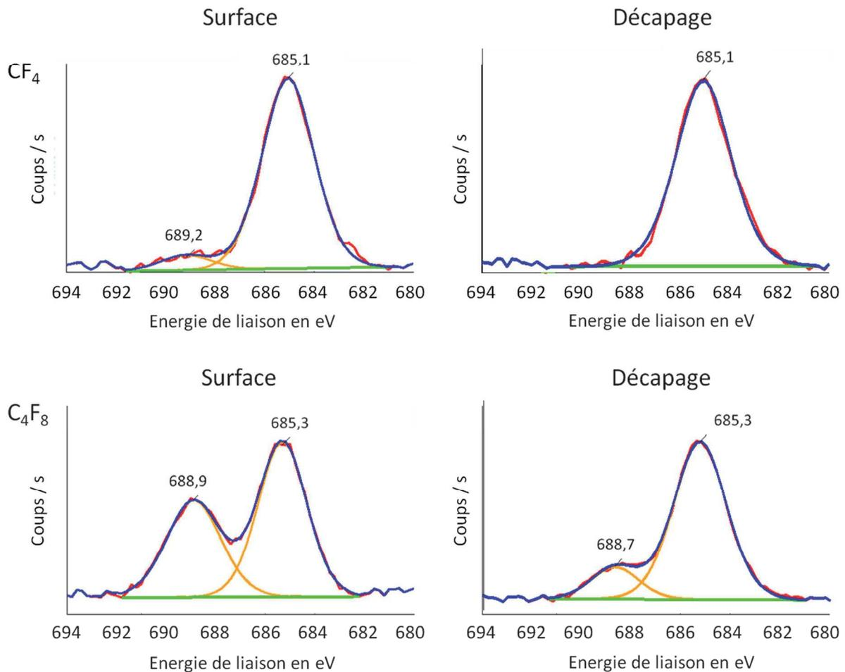
**Fig. III.6** – Comparaison des spectres XPS haute résolution d'un échantillon de ZnO dopé au gallium après fluoruration par plasma de  $\text{CF}_4$  à température ambiante (ZO-ZF-01) et après fluoruration par plasma de  $\text{C}_4\text{F}_8$  à température ambiante (ZO-ZF-03). Les analyses ont été effectuées avant et après décapage ionique et sont centrées autour des pics caractéristiques du fluor.
