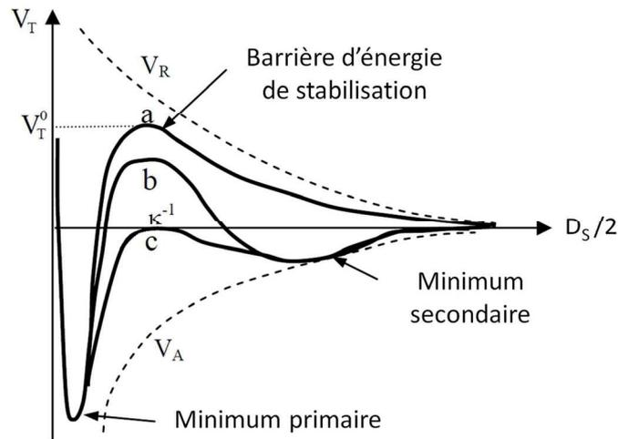
**Fig. I.32** - Représentation schématique de l'énergie potentielle totale  $V_T = V_A + V_R$  en fonction de la distance. a) les surfaces des particules se repoussent fortement ; b) les surfaces des particules sont en équilibre stable dans le minimum secondaire s'il est assez prononcé ; c) les surfaces des particules, en équilibre instable, donnent lieu à une agrégation limitée et une floculation lente des particules [143].
