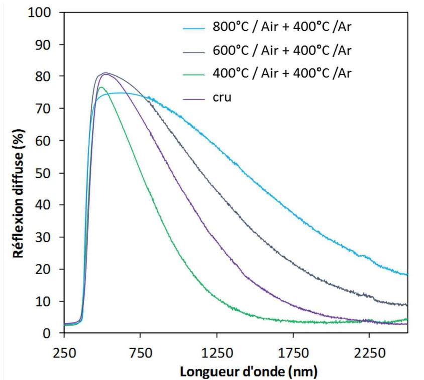
**Fig. II.38** - Spectres de réflexion diffuse des particules de ZnO dopé au gallium à 2,8 % molaire recuites sous air puis réactivées sous argon. Ces spectres sont présentés en comparaison avec le spectre de référence obtenu pour les particules de ZnO dopé au gallium à 2,8 % molaire crues.
