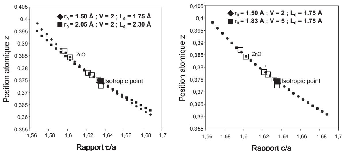
**Fig. II.27** – Modélisation de l'évolution de la position atomique  $z$  avec le rapport  $c/a$  pour une maille de volume minimisé obtenue pour un composé de structure de type würtzite avec : différentes distances  $L_0$  cation-anion mais avec des valences identiques (à gauche), différentes valeurs de valence mais avec des distances  $L_0$  identiques (à droite).
