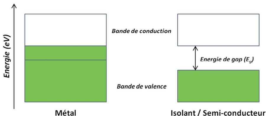
Fig. I.10 - Schéma de bandes de matériaux métalliques, semi-conducteurs et isolants.
