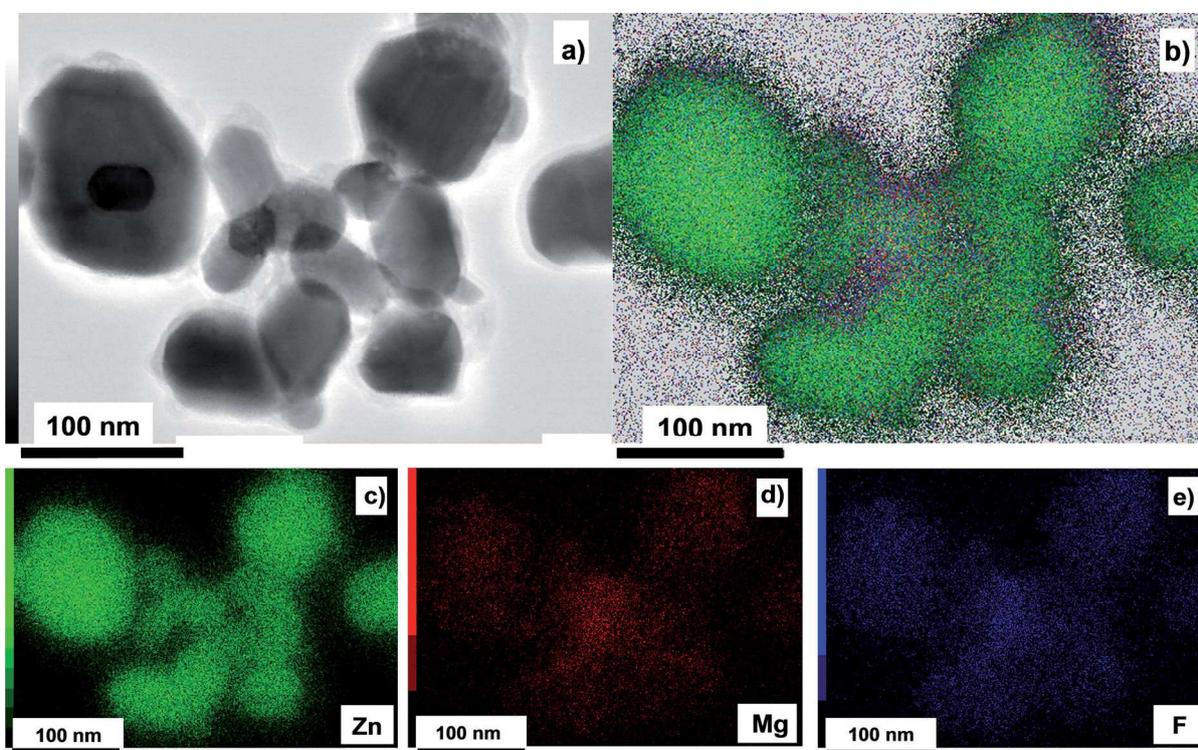
**Fig. III.12** - (a) Image STEM d'un échantillon de ZnO@MgF<sub>2</sub>, (b) Cartographie STEM-EDX avec superposition des signaux de Zn, Mg et F, (c-e) Cartographies STEM-EDX de Zn, Mg et F respectivement.
