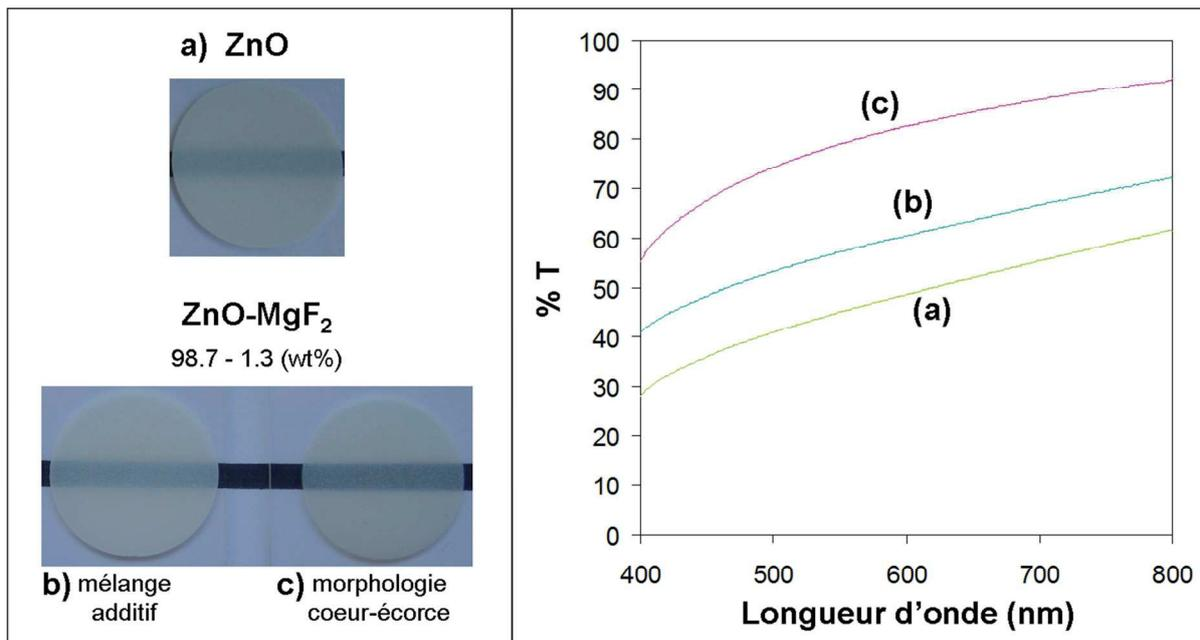
**Fig. III.19** - Photographies (à gauche) des films obtenus par sérigraphie pour différents types de poudres : a) poudre de ZnO, b) mélange de poudres ZnO (98,7 % mass.) et  $MgF_2$  (1,3 % mass.), c) poudre  $ZnO@MgF_2$ , et mesures de transmission directe sur la gamme de longueur d'onde du visible associées (à droite).
