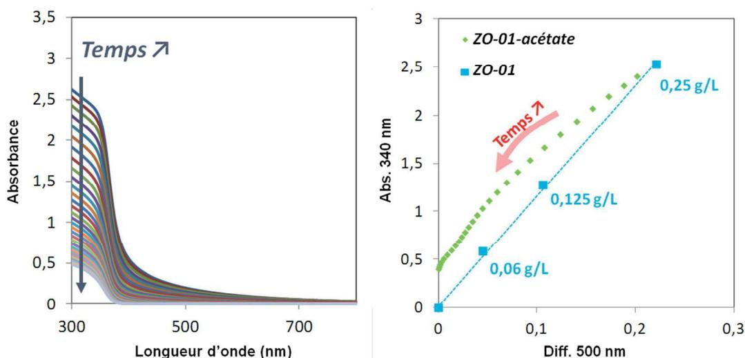
**Fig. III.30** – Suivi cinétique de spectres UV-Visible pour une solution de ZO-01-acétate et courbe représentant l'évolution de l'absorption à 340 nm en fonction de la diffusion à 500 nm associée à ces mesures. En bleu, la courbe référence pour le ZO-01 dans du DEG.
