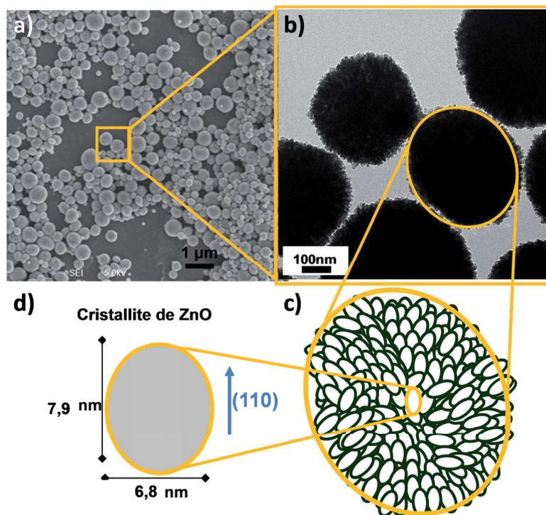
**Fig. II.4** - Morphologie des particules de ZnO élaborées dans du DEG à 0,1 M et 160°C (échantillon ZO-01) : a) cliché MEB and b) cliché MET d'agrégats; schéma descriptif c) d'un agrégat et d) d'une cristallite.
