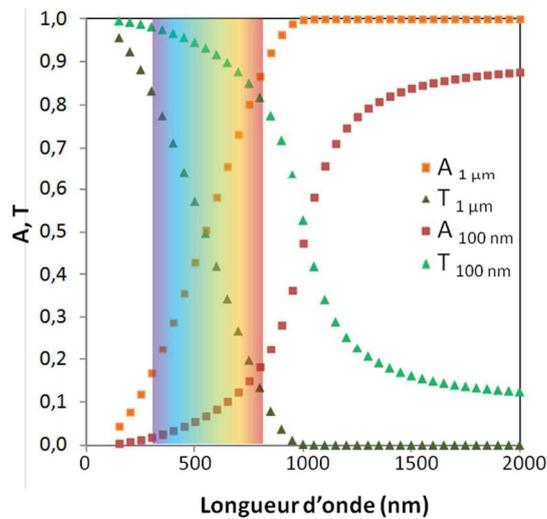
**Fig. I.20** - Evolution des fractions absorbée et transmise en fonction de la longueur d'onde pour différentes épaisseurs de particules traversées (100 nm et 1  $\mu\text{m}$ ) en négligeant les fractions réfléchiée et diffusée.
