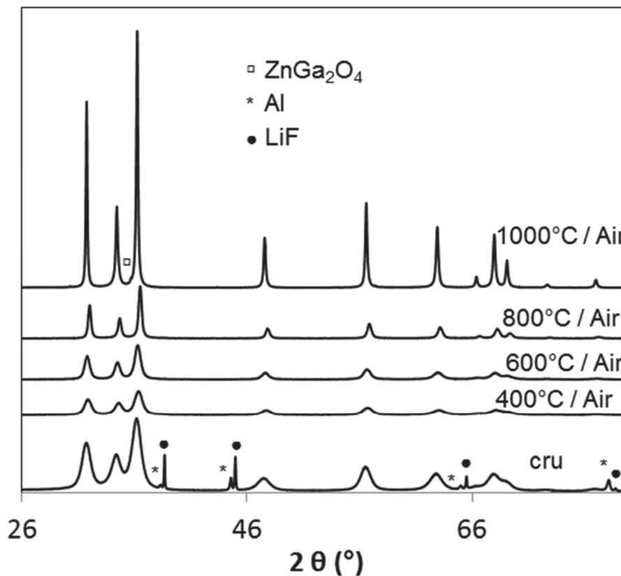
**Fig. II.39** – Diffractogrammes de rayons X de particules dopées au gallium à 2,8 % molaire avant et après recuit sous air pendant 3h et à différentes températures : 400, 600, 800 et 1000°C.
