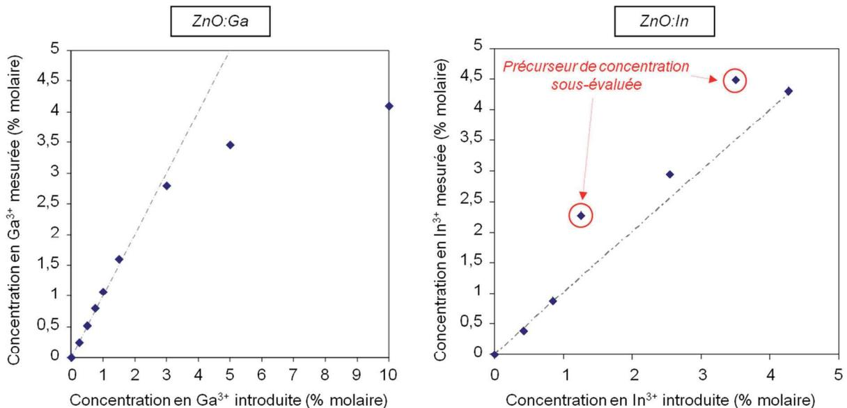
**Fig. II.30** – Concentrations en  $Ga^{3+}$  et  $In^{3+}$  dans les particules de ZnO dopé au gallium et à l'indium par rapport à la concentration en dopant initialement dans le DEG.
