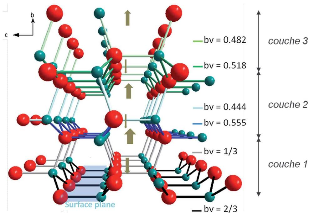
**Fig. II.21** – Schéma explicatif du calcul des valences de liaison ( $bv$ ) pour des couches de liaisons successives, de la surface au cœur du matériau, en considérant le plan de coupe perpendiculaire à l'axe  $b$ .
