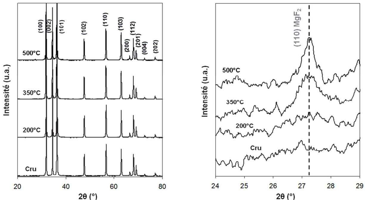
**Fig. III.14** – Diffractogrammes de rayons X de particules cœur-écorce ZnO@MgF<sub>2</sub> avant et après recuit à différentes températures (4 h sous atmosphère d’argon). Les pics de diffraction sont attribués à une structure de type wurtzite ZnO (sur la figure de gauche). Le pic le plus intense de MgF<sub>2</sub> est exalté avec l’augmentation de la température de recuit (sur la figure de droite).
