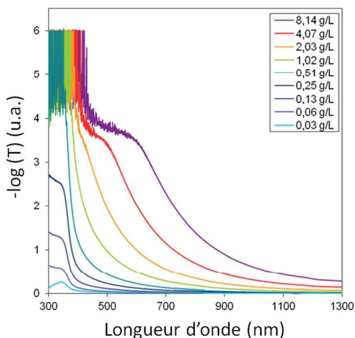
**Fig. III.27-** Spectres UV-Visible de dispersions de ZnO élaborées en milieu DEG pour différentes concentrations en ZnO. Il est à noter que la limite de détection de l'appareillage est atteinte pour des valeurs de  $-\log(T)$  supérieures à 4.
