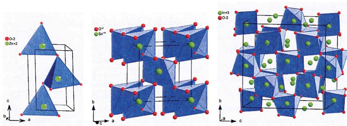
**Fig. 1.13** - Structures cristallines des TCOs les plus usuels (ZnO, SnO<sub>2</sub> et InO<sub>3</sub>).
