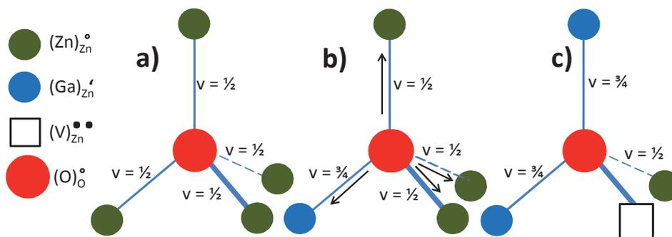
**Fig. II.43** – Calculs de liaisons de valence autour d'un oxygène dans trois situations différentes : a) l'oxygène est entouré de quatre  $\text{Zn}^{2+}$ , b) l'oxygène est entouré de trois  $\text{Zn}^{2+}$  et d'un  $\text{Ga}^{3+}$ , c) l'oxygène est entouré d'un  $\text{Zn}^{2+}$  et d'un « triple défaut ».
