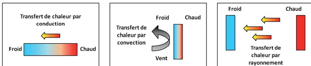
Fig. I.2 - Schématisation des trois modes de transfert.
