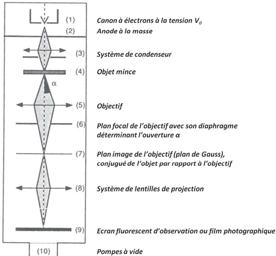
Fig. IV.4 – Eléments d'un microscope électronique à transmission [235].
