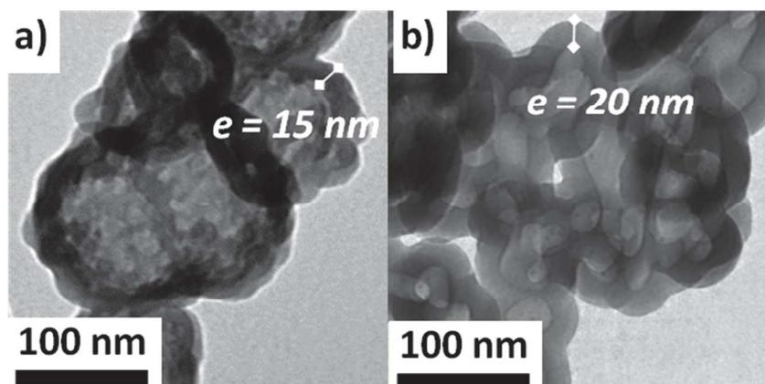
Fig. III.25 – Clichés MET permettant d'apprécier les épaisseurs des coques de silice des particules ZO-01@SiO<sub>2</sub> et ZO-12@SiO<sub>2</sub>.
