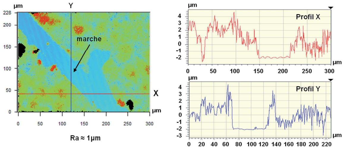
**Fig. III.18** – Mesures de rugosité autour d'une marche pour un film de particules de ZnO élaboré par sérigraphie : cartographie de surface (à gauche) et profils selon z (c'est-à-dire en épaisseur) des coupes X et Y (à droite) autour d'une marche créée par abrasion du film.
