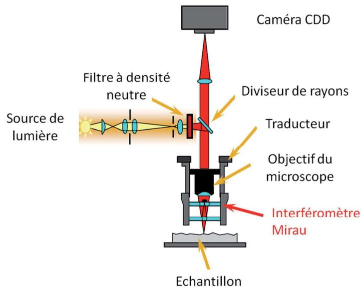
Fig. IV.5 – Schéma d'un profilomètre optique de type WYCO NT1100 de Veeco [237].
