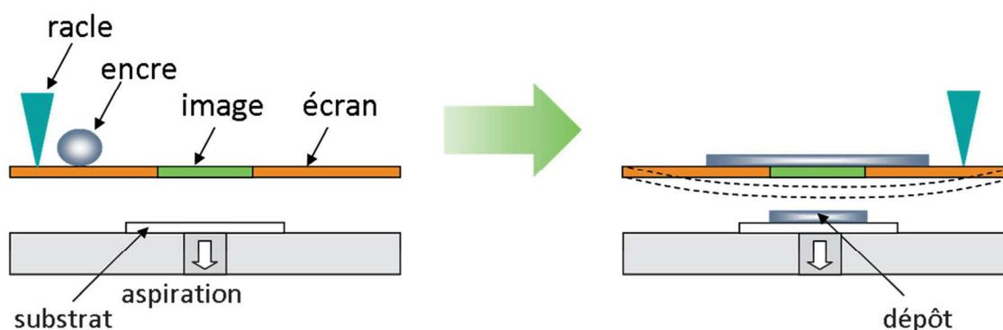
**Fig. III.17** - Schématisation de l’élaboration d’un film par sérigraphie.
