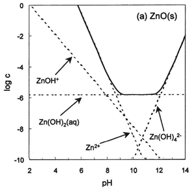
**Fig. I.35** - Diagrammes de stabilité d'un système ZnO(s)-H<sub>2</sub>O à 25°C en fonction du pH [149].
