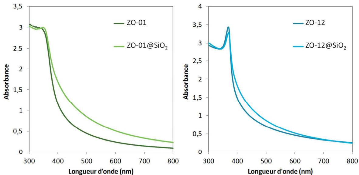
**Fig. III.26** – Spectres UV-Visible de dispersions de particules de ZnO et de ZnO@SiO<sub>2</sub> dans l'eau. A gauche, les courbes obtenues pour des agglomérats de ZnO submicroniques. A droite, les courbes obtenues pour des nanoparticules de ZnO de 30 nm. Les mesures ont été effectuées pour des concentrations en ZnO similaires (c'est-à-dire pour des valeurs d'absorption à 340 nm comparables).
