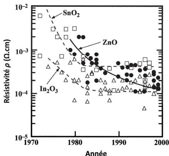
**Fig. I.14** - Résistivités référencées dans la littérature (1970-2000) pour des TCO dopés et non dopés de matrice binaire de type  $\text{SnO}_2$  ( $\square$ ),  $\text{In}_2\text{O}_3$  ( $\Delta$ ) et  $\text{ZnO}$  ( $\bullet$ ) [34].
