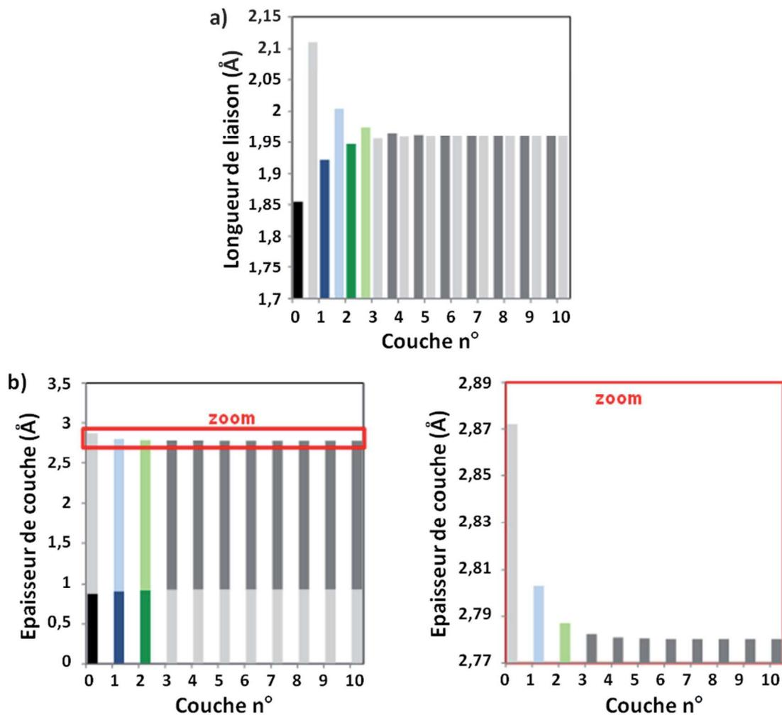
**Fig. II.22** – Evolution calculée de la longueur de liaison (a) et de l'épaisseur de couche (b et zoom) (d'après des projections sur l'axe vertical de la surface de coupe) pour des couches successives de liaisons, de la surface vers le cœur du matériau, comme illustré en Fig. II.21.
