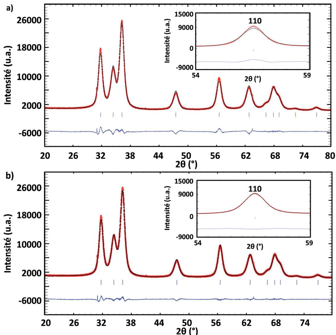
**Fig. II.3** – Diffractogrammes de rayons X et affinements Le Bail pour un modèle isotrope (a) et pour un modèle anisotrope selon l’axe (110) (b) de l’échantillon ZO-01. Pour chaque modèle, les données expérimentales sont présentées en rouge, les données calculées sont présentées en noir et la fonction différence apparaît en bleu.
