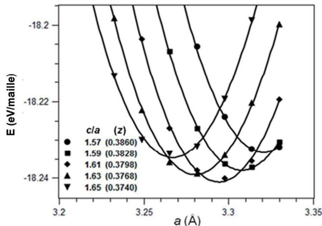
**Fig. II.26** – Énergie de valence en fonction du rapport  $c/a$  et du paramètre de maille  $a$ , calculé par DFT (approximation GGA), pour le groupe d'espace  $P6_3mc$ . Dans chaque cas (c'est-à-dire pour des valeurs de  $c/a$  et  $a$  fixées), la valeur optimale pour la position  $z$  a été calculée (valeur entre parenthèses).
