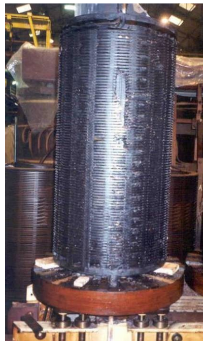
Figure 22 : Echauffement excessif d'un enroulement
