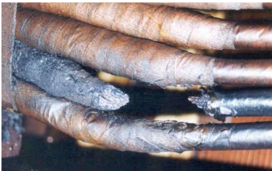
Figure 32 : Coupure suite à la fusion d'un conducteur
