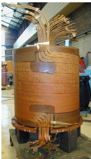
Figure 8 : Enroulement de transformateur
