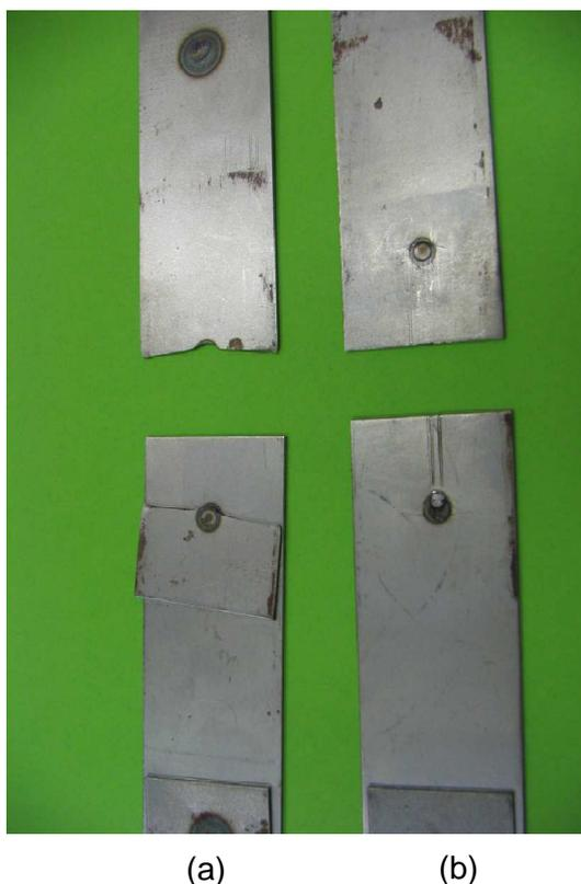
Figure 2.20 – Rupture (a) par fissuration, (b) par cisaillement d'une éprouvette soudée par point
