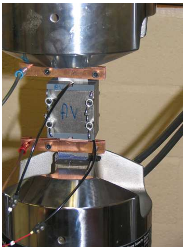
Figure 2.16 – Montage de l'éprouvette équipée du raidisseur pour la mesure des ddp
