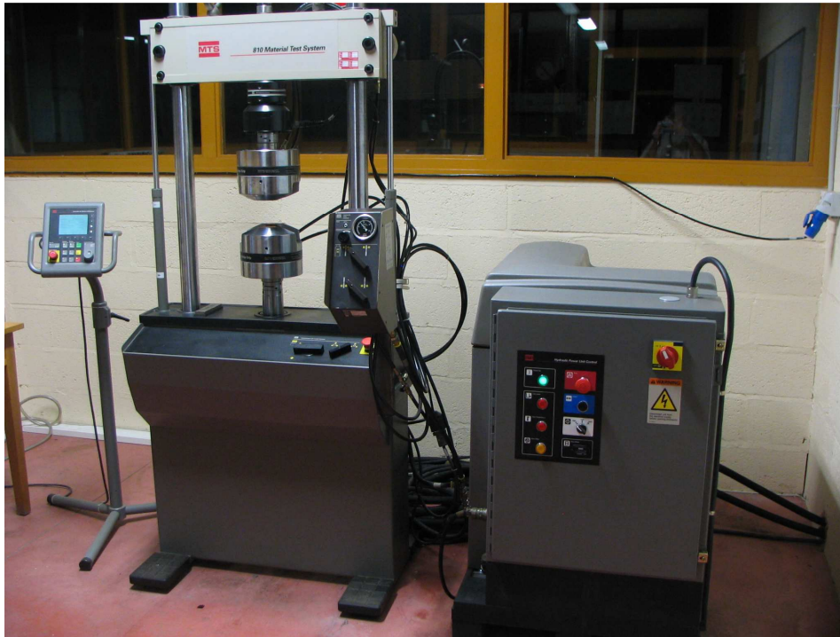
Figure 2.4 – Ensemble machine de fatigue et groupe hydraulique MTS
