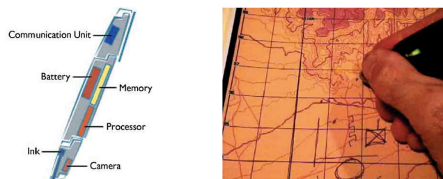
FIGURE 2.13 – Interaction multimodale tangible dans le système militaire NISMap. L'utilisateur peut utiliser la voix et l'écriture afin d'annoter numériquement des cartes papier tramées. Illustration extraite de [Cohen et McGee, 2004].
