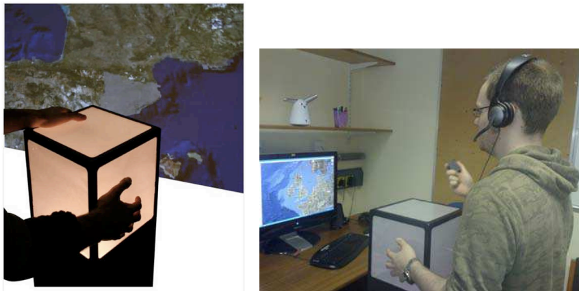
FIGURE 8.33 – Utilisation du Cubtile seul (à gauche) ou avec d'autres modalités, comme la voix et le Shake (à droite) pour une tâche de manipulation 3D avec l'application GoogleEarth.
