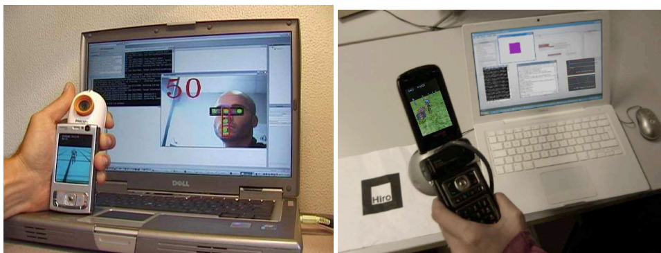
FIGURE 8.20 – Jeu 3D sur téléphone mobile contrôlé avec le déplacement de la tête (à gauche) et avec le déplacement du téléphone en utilisant Artoolkit (à droite).
