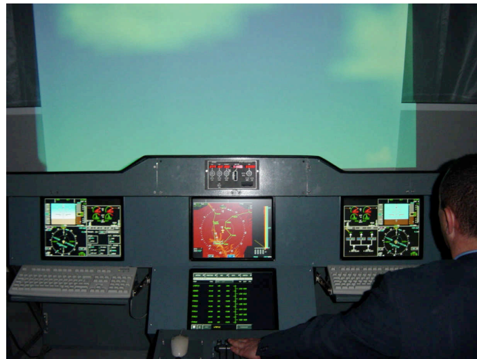
FIGURE 2.15 – Interface de cockpit d'avion utilisant des modalités en entrée redondantes, comme plusieurs claviers, afin de contourner les pannes de dispositifs. Illustration extraite de [Barboni et al. , 2007].
