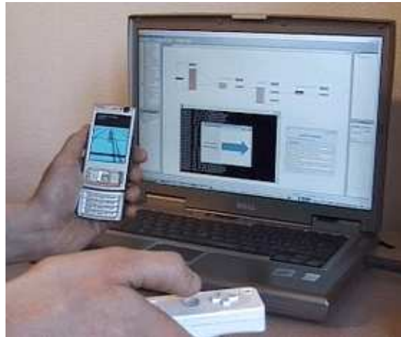
FIGURE 8.31 – Reconnaissance des gestes avec la wiimote afin d'interagir sur un jeu sur téléphone mobile.
