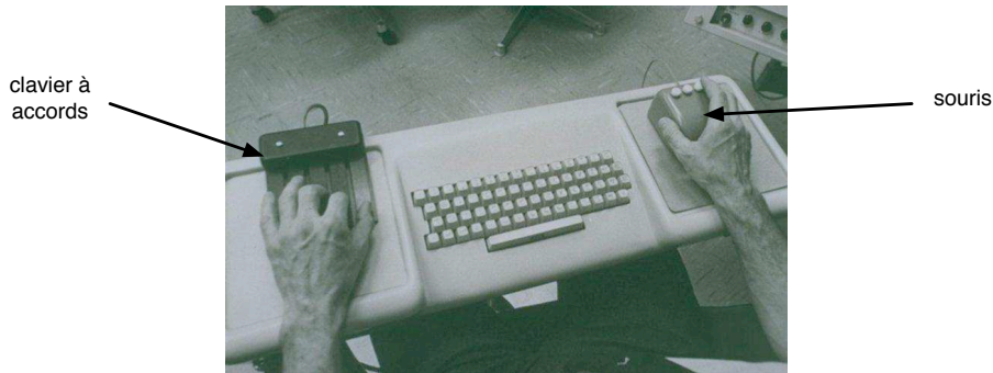
FIGURE 2.2 – Système NLS avec clavier à accords et souris.
