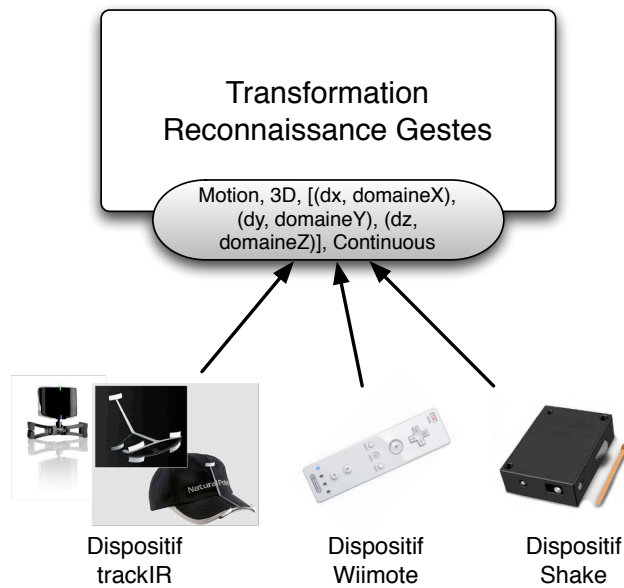
FIGURE 8.32 – Plusieurs modalités exploitant un composant Transformation unique.
