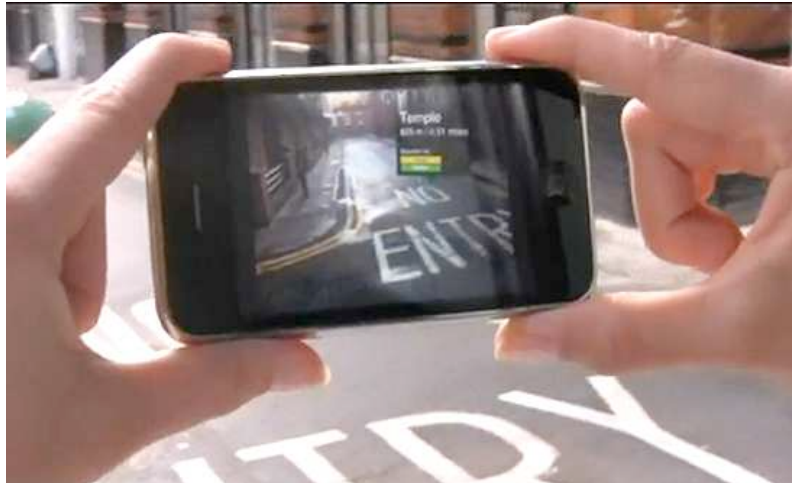
FIGURE 2.11 – Nearest Tube, application multimodale utilisant le geste et la géo-localisation pour afficher des informations augmentées.
