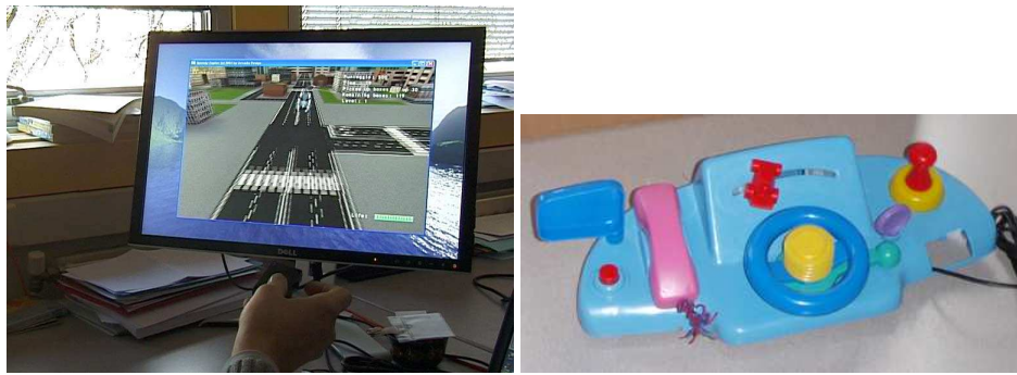
FIGURE 8.17 – Contrôle du jeu de vol avec le geste en utilisant le Shake (à gauche) et en utilisant les capteurs interface-Z pluggés sur un volant de jouet en plastique (à droite).
