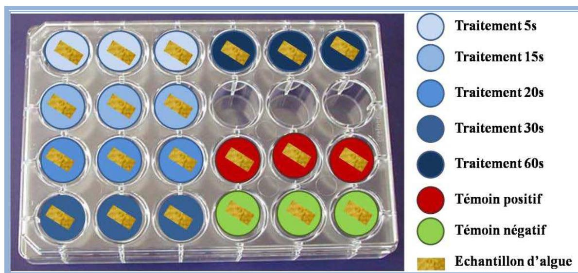
**Figure 25** : Schéma de la disposition des échantillons d'algues dans une plaque 24 puits pour le marquage de viabilité cellulaire servant à l'évaluation de l'effet de l'extraction de surface sur la lyse des cellules algales
