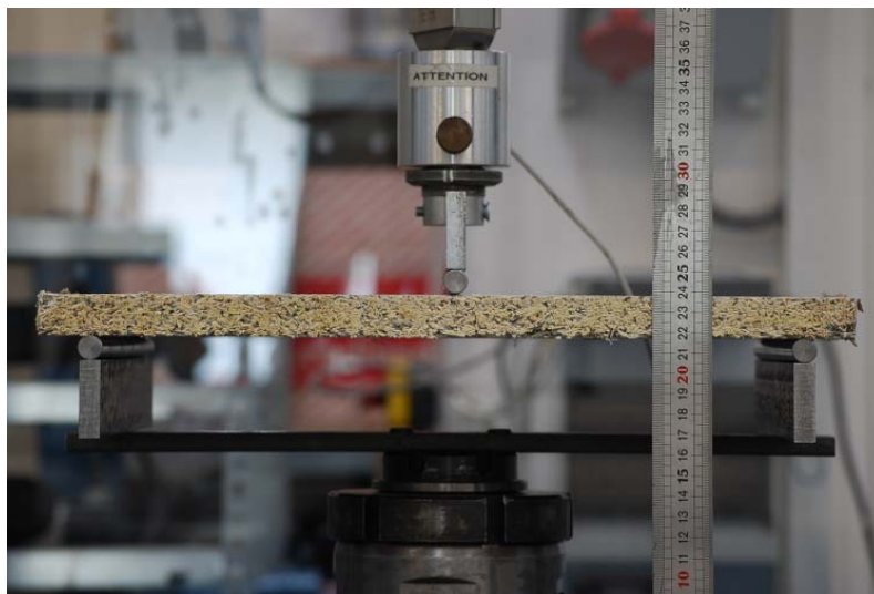
Figure 5-29 : Schéma et montage de l'essai de flexion trois points sur une plaque de béton de chanvre
