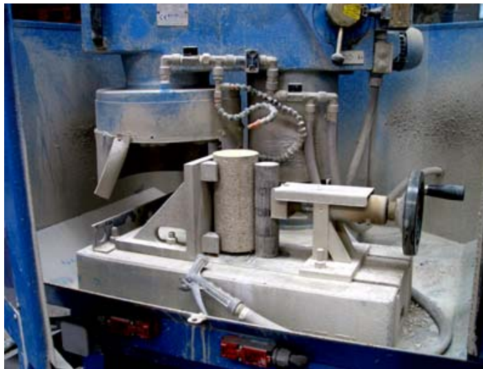
Figure 3-6 : Surfaçage du béton de chanvre à l'aide d'une rectifieuse
