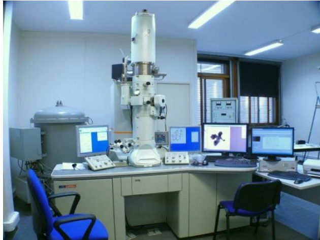
Figure 19. L'appareil de Microscopie électronique en Transmission utilisé pour les images TEM au CIRIMAT
