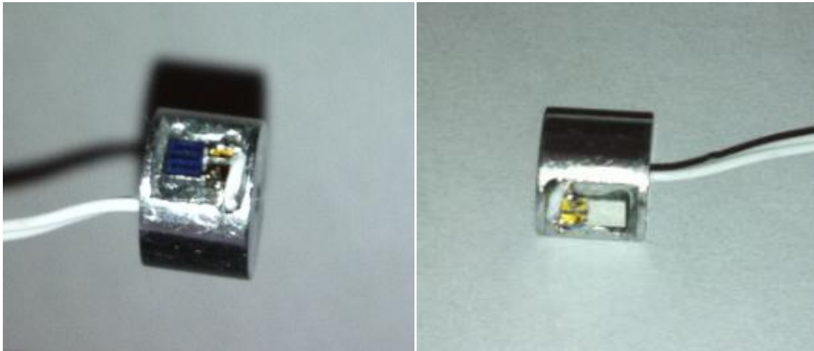
Figure 82. Photos des porte puces avec la puce d'initiation collée et câblés
