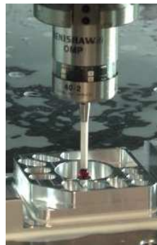
Figure 2.4 – Palpeur à transmission IR monté sur la broche [Peyrucat 2013].
