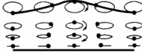
FIGURE 1.3 – Mouvements orbitaux dans les houles progressives. Les orbites sont des ellipses d'autant plus aplaties que la profondeur d'eau est faible ou que les particules fluides sont proches du fond. A la fin de chaque cycle de houle, chaque particule revient à sa position initiale.
