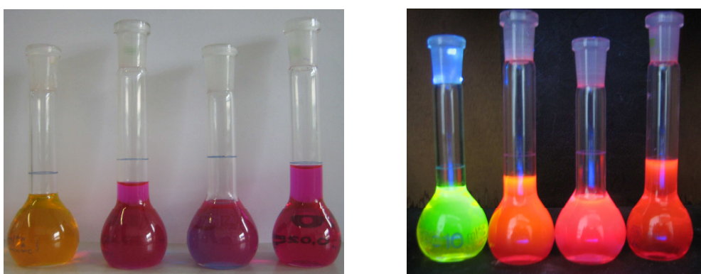
Figure 5.20 : Solutions dans le dichlorométhane des composés 35 , 72 , 73 et 71 à la lumière naturelle (gauche) et sous lampe UV (droite) ( c \sim 10^{-5} M ).
