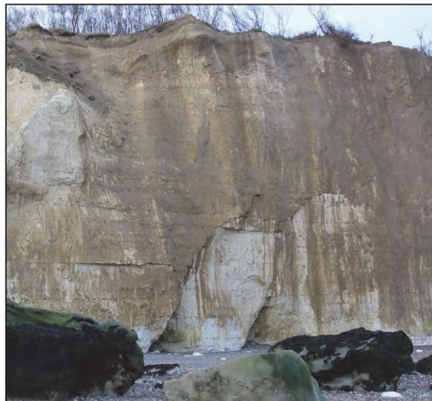
Figure 9.24 : Départ de matériel en pied de falaise à Sainte-Marguerite-sur-Mer après de fortes conditions d'agitation marine (Letortu, 30/12/2011)
