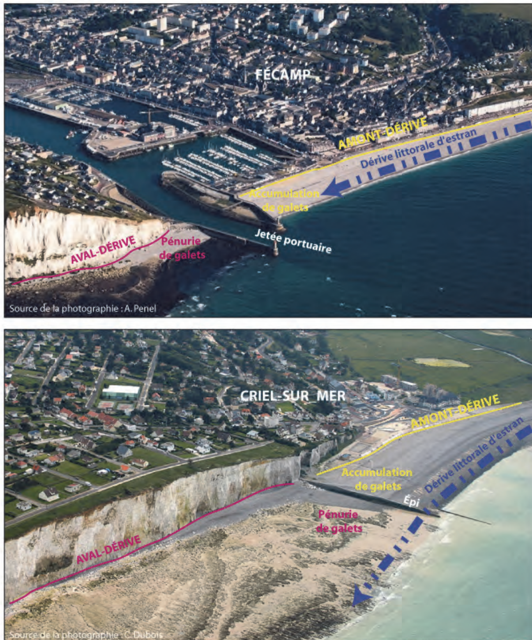
Figure 6.9 : Jetée portuaire de Fécamp et épi majeur de Criel-sur-Mer et leurs effets sur le transit sédimentaire
