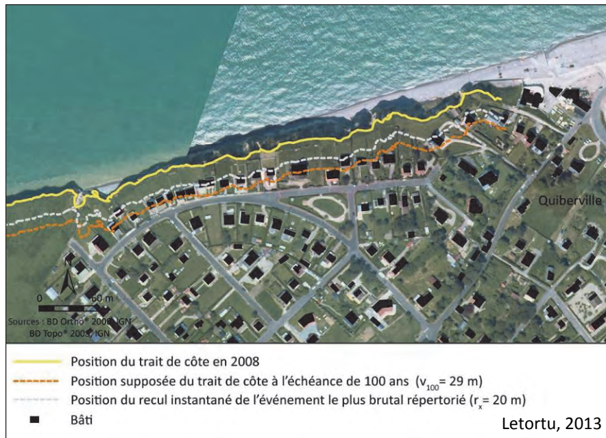
Figure 7.17 : Positions du trait de côte déduites du recul instantané maximal et de la valeur de recul moyen extrapolée sur 100 ans à Quiberville
