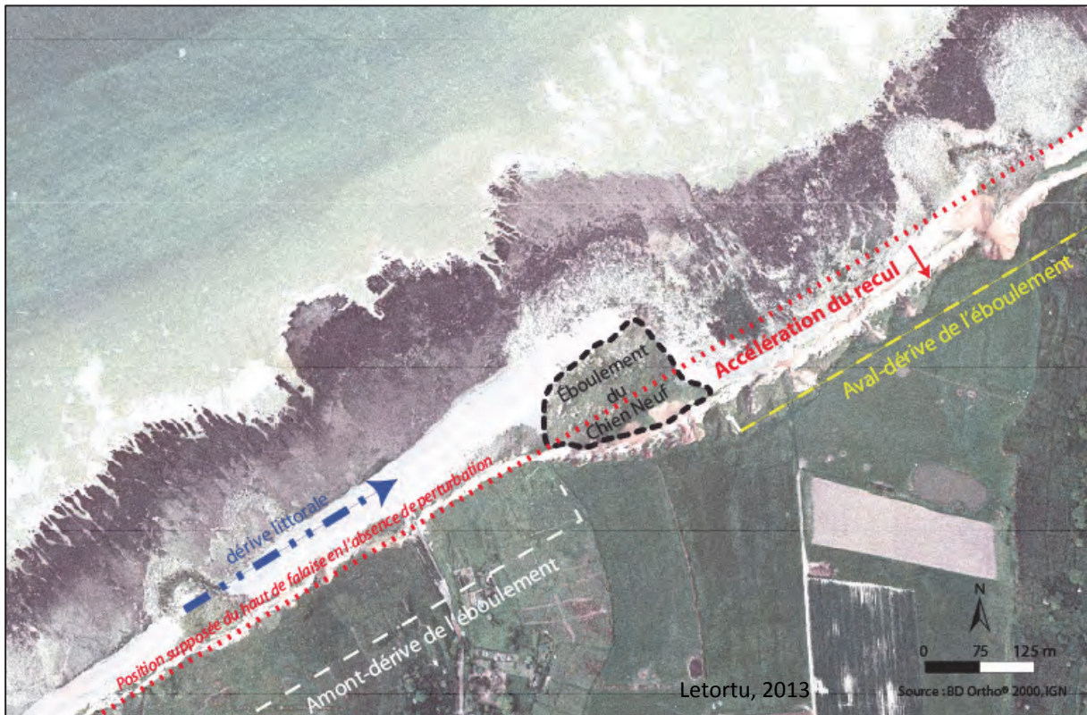
Figure 6.11 : Accélération de l'érosion en aval-dérive de l'éboulement du Chien Neuf
