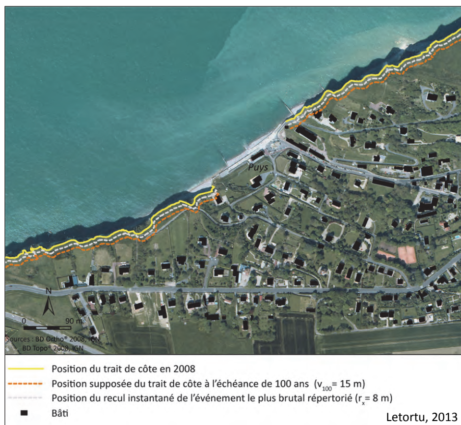
Figure 7.19 : Positions du trait de côte déduites du recul instantané maximal et de la valeur de recul moyen extrapolée sur 100 ans à Puys (est de Dieppe)
