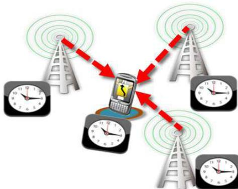
FIGURE 1.2 – Principe du positionnement endogène.
