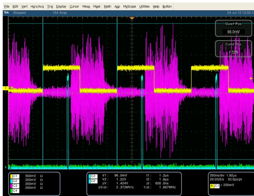
FIGURE 5.9 – Signaux DS-CDMA ULB acquis par l'oscilloscope.
