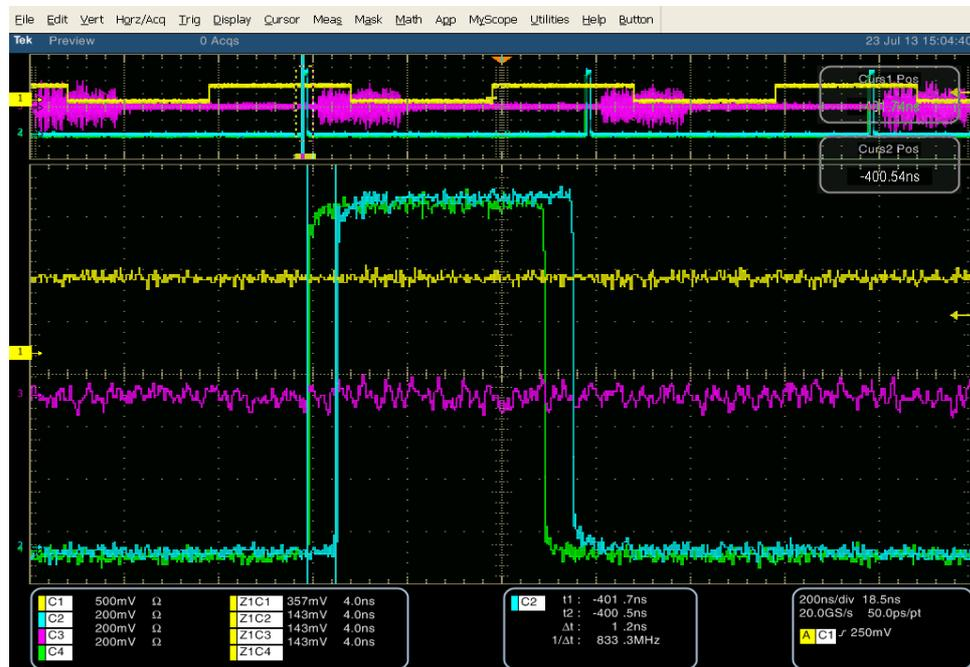
FIGURE 5.7 – Problème de synchronisation entre deux générateurs *esclaves*.
