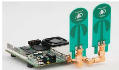
(b) Le module P410 MRM (*PulsON 410 Monostatic Radar Module*) de Time Domain.
