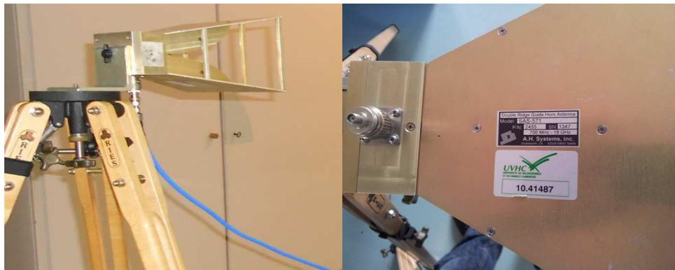
FIGURE 5.2 – Antenne cornet utilisé comme émetteur.
