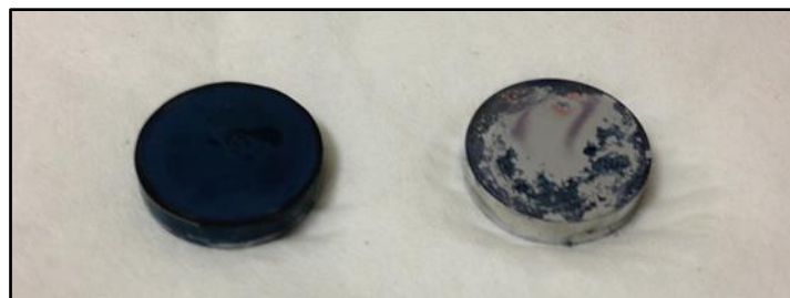
Figure 68 - Images de pastilles de CoCr-PDA-PCD après 6 jours dans le PBS. Sur la gauche de l'image, le revêtement de PCD a subi un traitement thermique (150°C-1h) alors que sur la droite de l'image le revêtement n'a pas subi de traitement thermique
