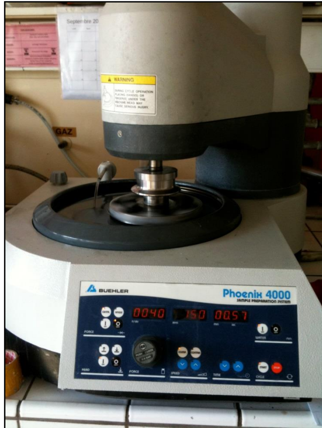
Figure 18 - photo de la polisseuse automatique PHOENIX 4000, (Buehler, Germany) permettant de polir 6 pastilles à la fois ; le temps, la pression et la vitesse de rotation sont déterminés par l'opérateur
