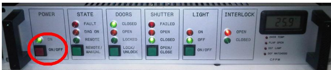
Figure 3.11 : Photographie du bloc contrôleur. On distingue en dessous de « STATE » le témoin de mode « REMOTE » dans lequel le PIXSCAN est totalement pilotable grâce à piXface.
