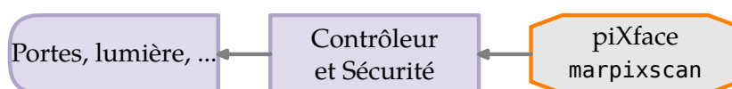
Figure 3.10 : Bloc contrôleur. La source de rayons X est pilotable grâce à son contrôleur directement connecté sur marpixscan
