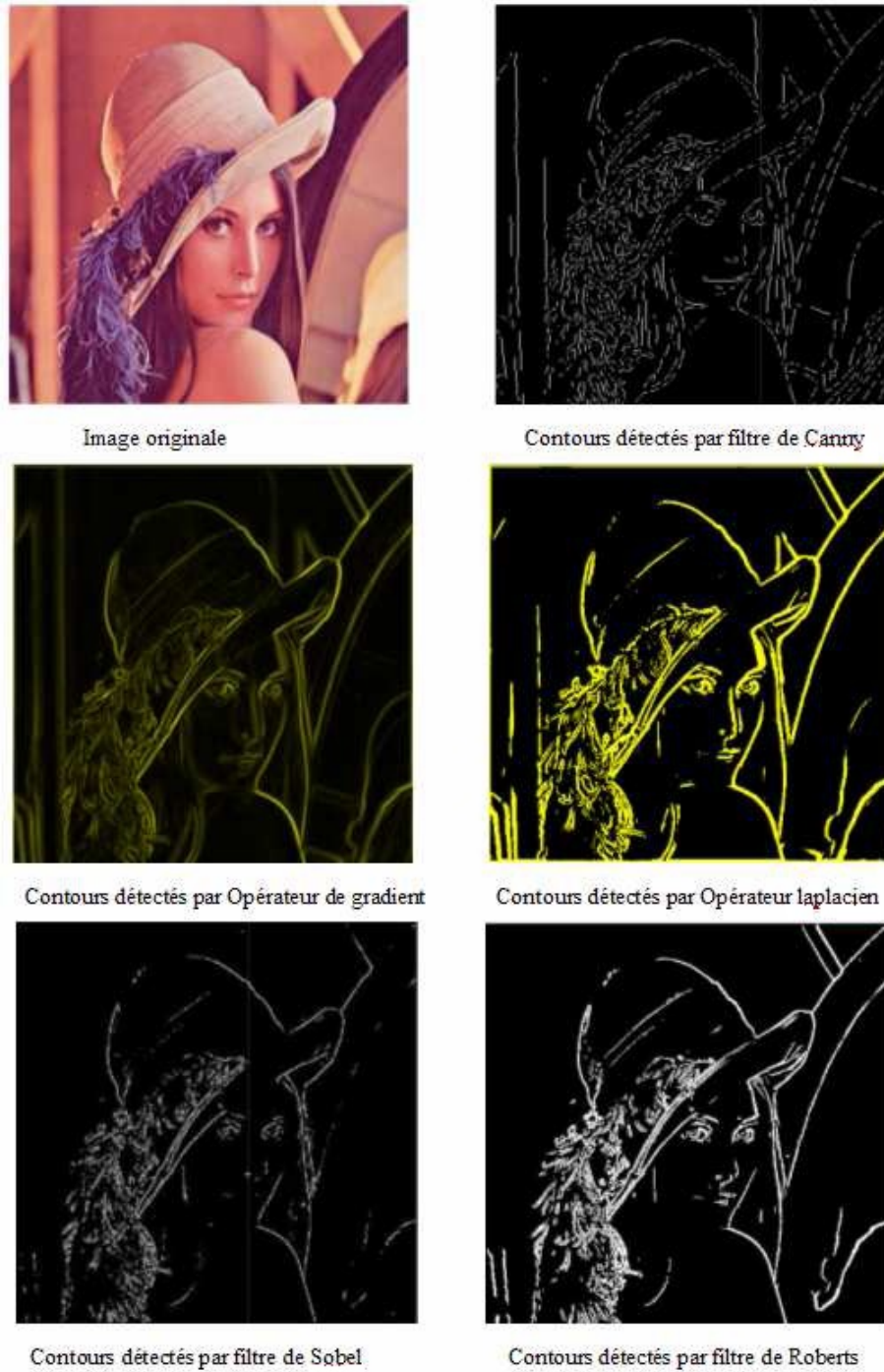
FIG. 3.4 – Détection de contours sur l'image Léna.
