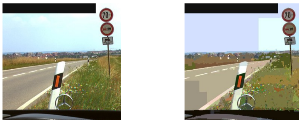
FIG. 3.7 – Segmentation par division/fusion.
