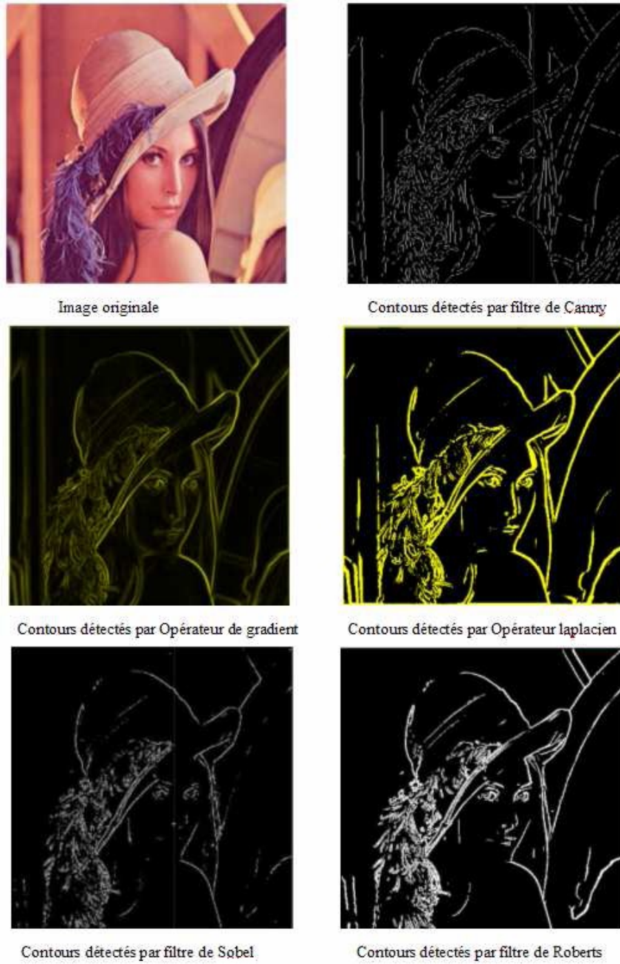
FIG. 3.4 – Détection de contours sur l'image Léna.
