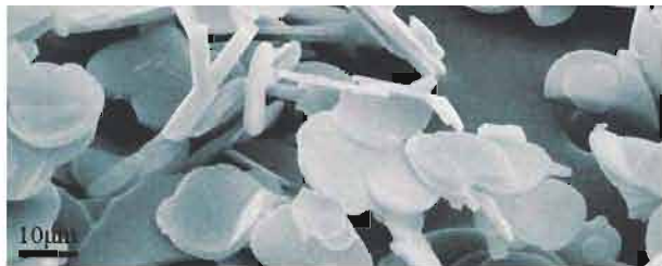
FIGURE 1.23: Image de microscopie optique de poudre de h-BN.
